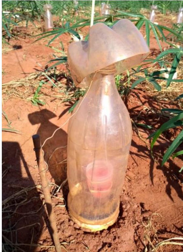
Figura 4 Câmara estática de captação de N-NH 3 , semi-aberta, contendo solução diluída H 2 SO 4 , confeccionada com garrafa PET.
