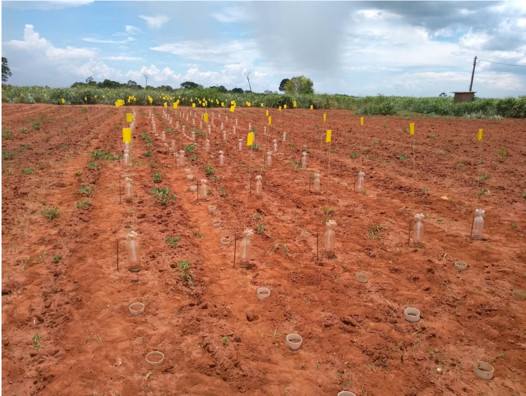
Figura 3 Câmaras de captação semi aberta instaladas nas estrelinhas da cultura da mandioca com 35 dias após o plantio e os pontos de coleta para cada tratamento.
