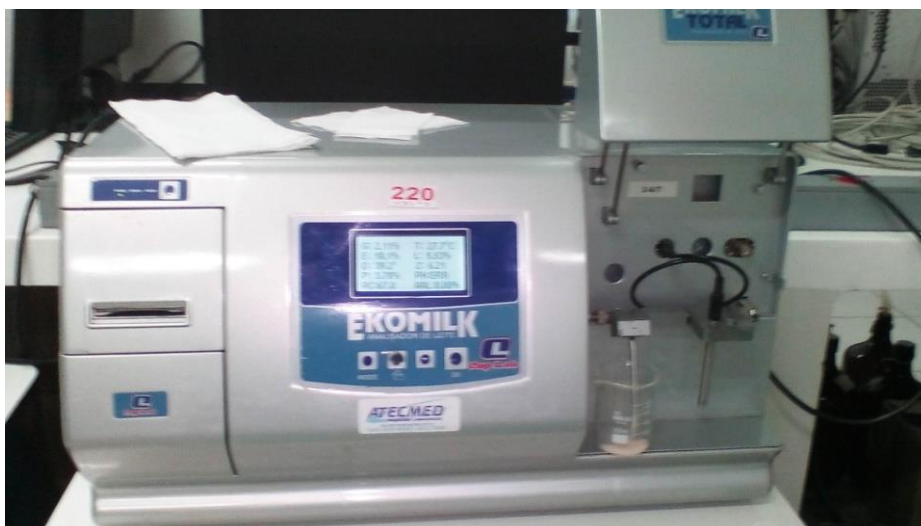
Figura 3: Aparelho de análise ultrassônica de leite, Ekomilk Total®, Centro Mesoregional de Excelência do Leite-CMEL, Departamento de Zootecnia- DZO, Centro de Ciência Agrárias-CCA, Universidade Estadual de Maringá-UEM.
