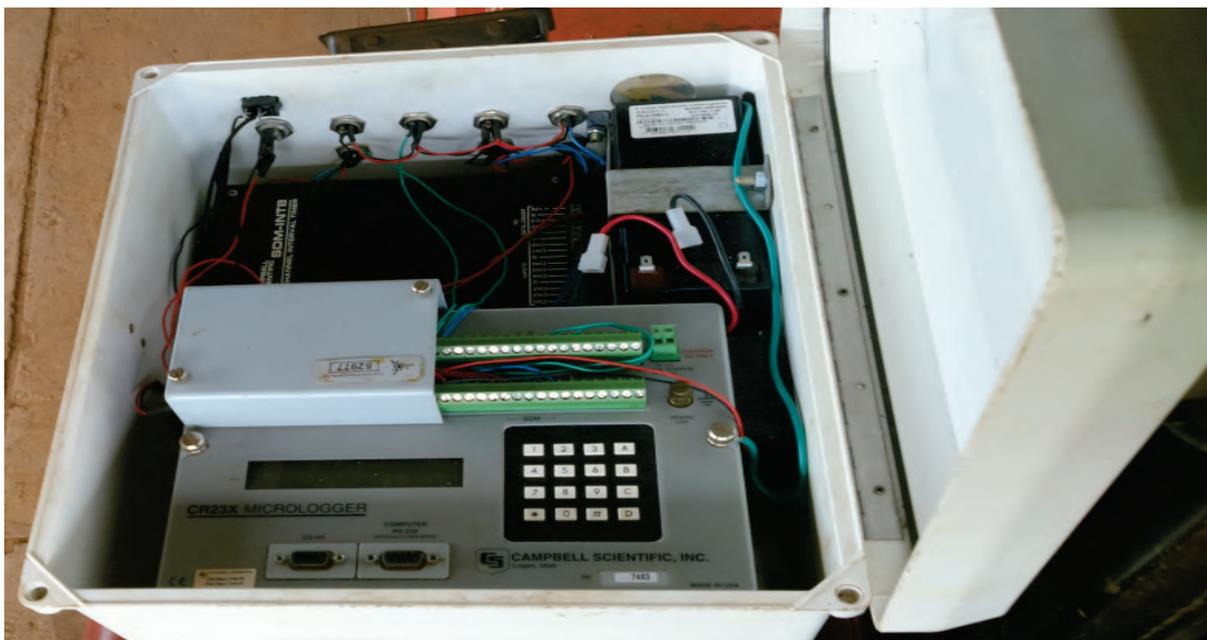
Figura 12. Central de armazenamento de dados Micrologger CR23X.
