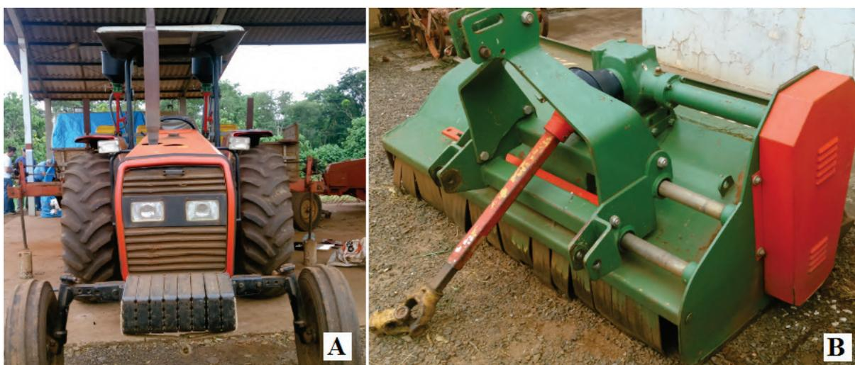
Figura 7. Máquinas utilizadas no experimento – Trator MF 275 (A); Triturador de palha horizontal (B).
