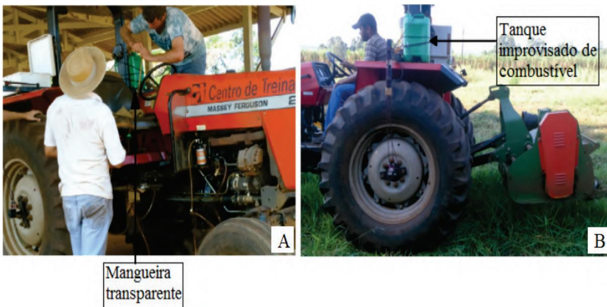
Figura 8. Tanque improvisado de combustível – mangueira transparente sendo afixada (A); tanque de combustível improvisado instalado (B).
