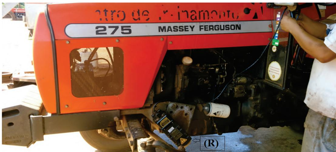
Figura 10. Radar (R) para medir a velocidade real de deslocamento.
