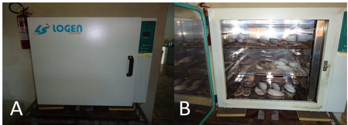
Figura 11 – Em A, fotografia da estufa de ar com ventilação forçada (Ls Logen Scientific – nova ética modelo 400/4nd). Em B fotografia das peças anatômicas congeladas dentro da estufa para o início do período de secagem.
