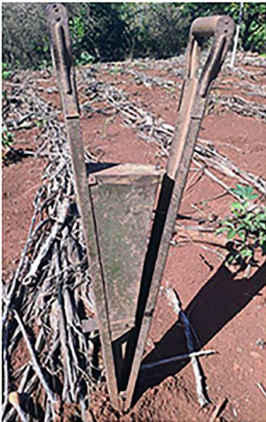
Figura 27 - Máquina manual de plantar grãos, foto tirada na propriedade da família Batista
