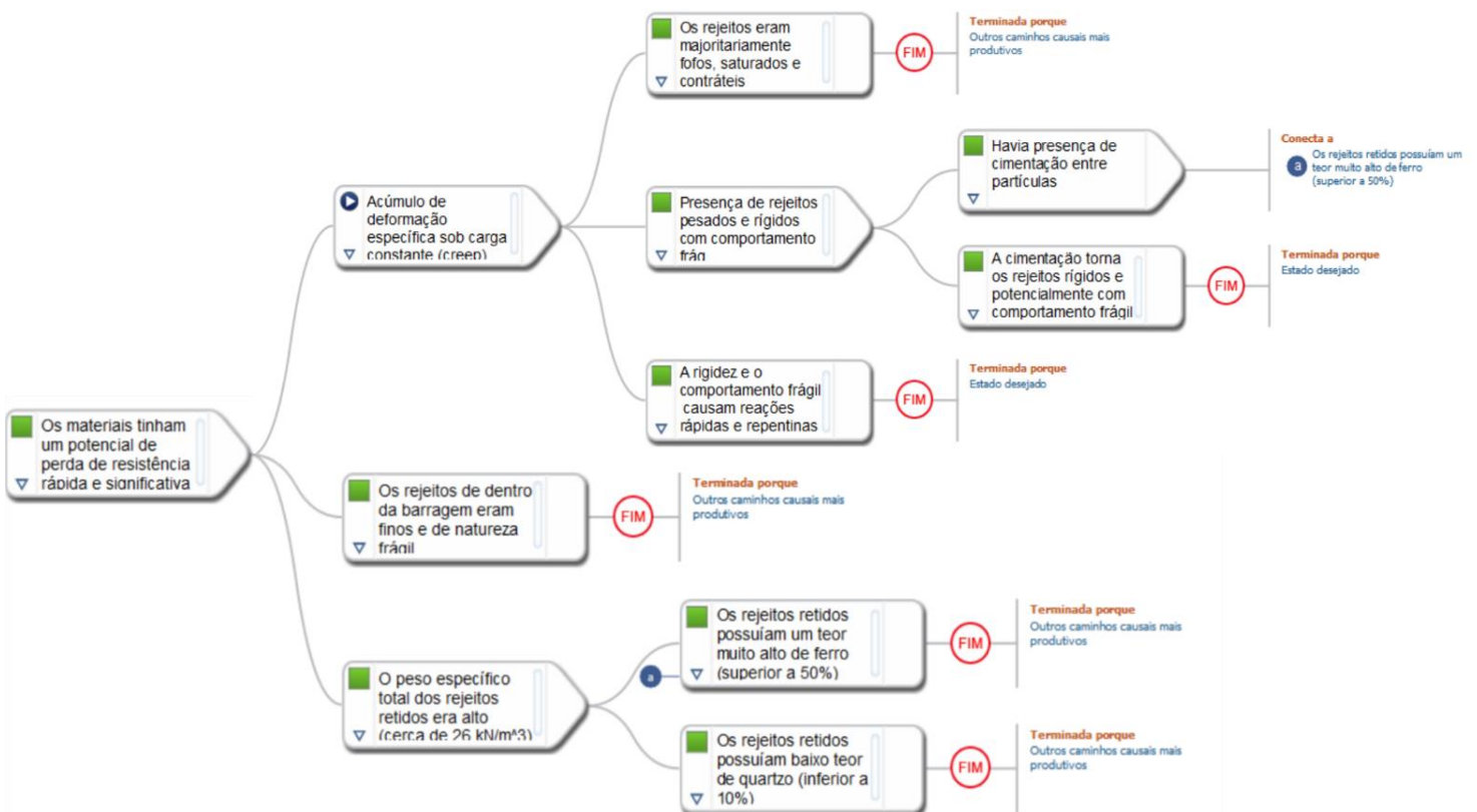
Figura 19 - Causas do potencial de perda de resistência rápida e significativa dos materiais
