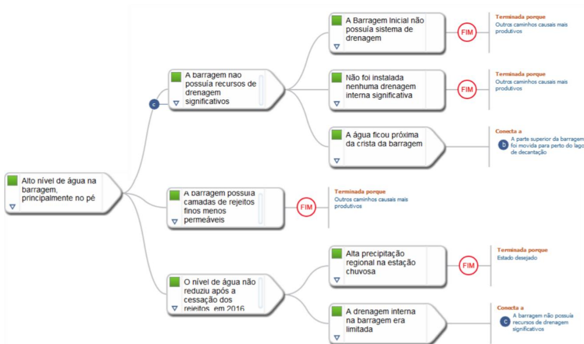
Figura 16 - Causas do alto nível de água na barragem
