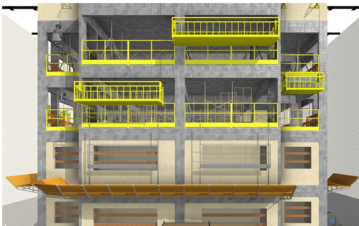
Figura 2 – Modelo BIM com objetos associados ao SST no canteiro (1)
