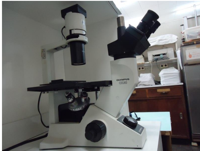
Figura 7 – Microscópio óptico de luz invertida (Olympus CK 40) usado para contagem de UFC/campo do ensaio de adesão em superfície de poliestireno
