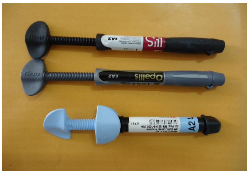
Figura 9 – Resinas compostas Llis®, Opallis® e Z350® usadas para o ensaio de adesão em superfície de resinas compostas
