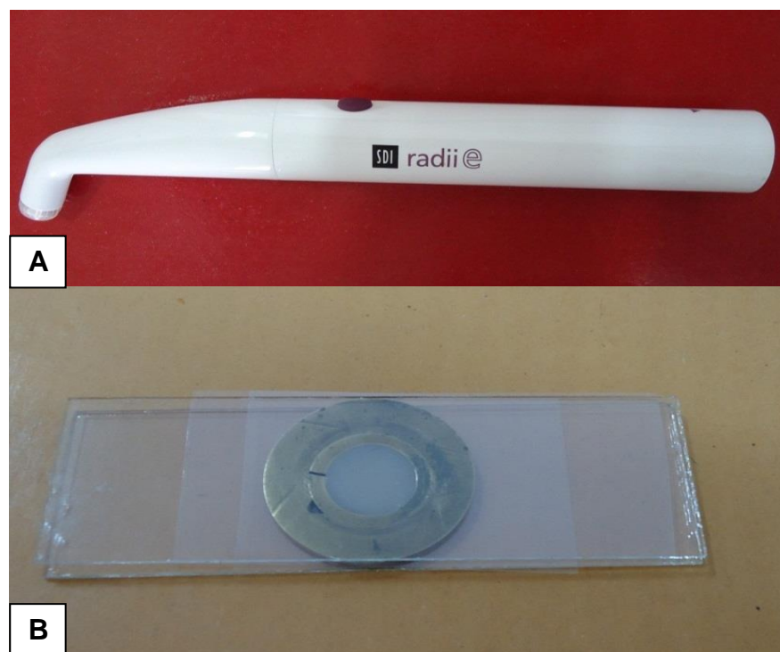
Figura 11 – A) Aparelho fotopolimerizador LED; B) Matriz com resina composta interposta com duas lâminas de vidro protegidas com película de retroprojeto
