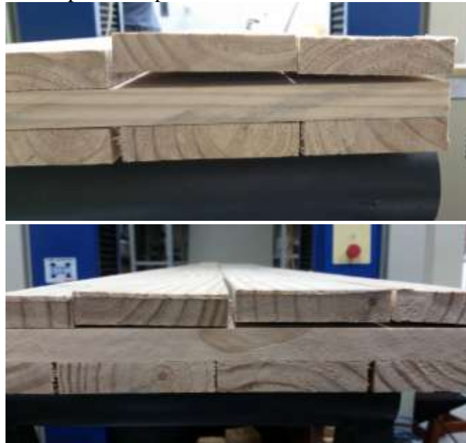
Figura 4.6 – Ruptura dos painéis com consumo de adesivo de 120 \text{ g/m}^2
