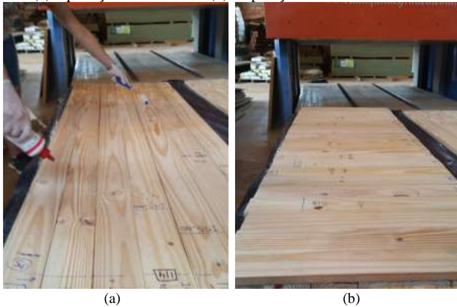
Figura 3.7 – (a) Aplicação do adesivo e (b) disposição das lamelas da camada adjacente
