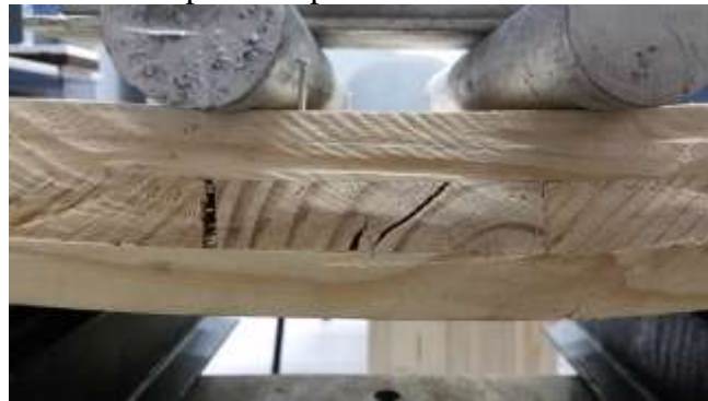
Figura 4.15 – Ruptura do painel P9 testado ao cisalhamento
