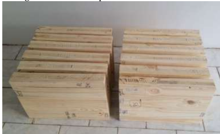
Figura 3.10 – Painéis para o ensaio de cisalhamento
