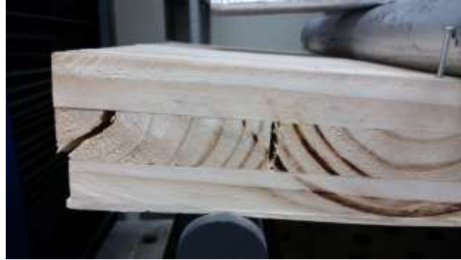
Figura 4.14 – Ruptura do painel P7 testado ao cisalhamento
