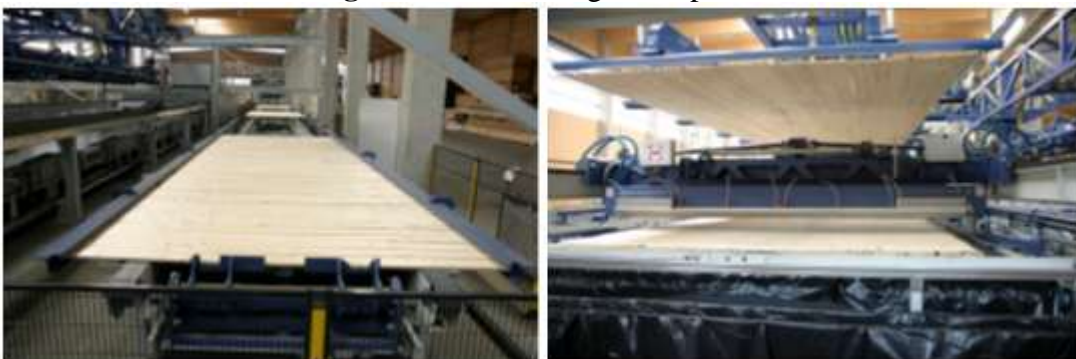
Figura 2.12 – Montagem do painel
