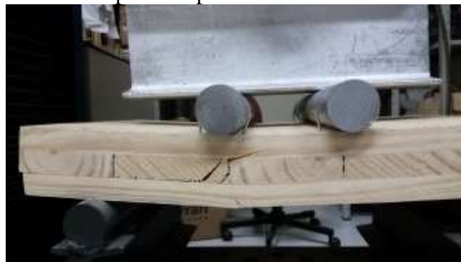
Figura 4.16 – Ruptura do painel P11 testado ao cisalhamento
