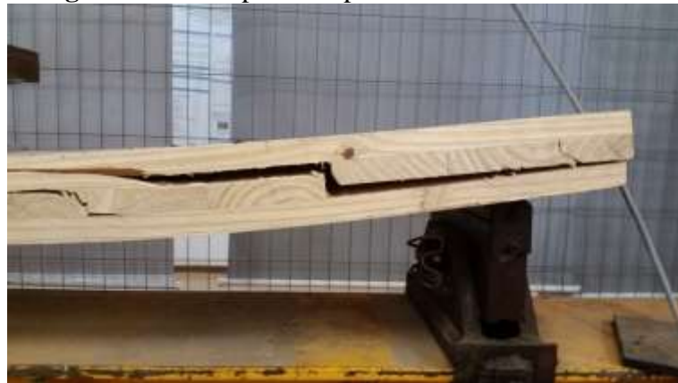
Figura 4.10 – Ruptura do painel P11 testado à flexão
