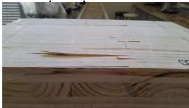
Figura 4.12 – Ruptura do painel P8 testado ao cisalhamento
