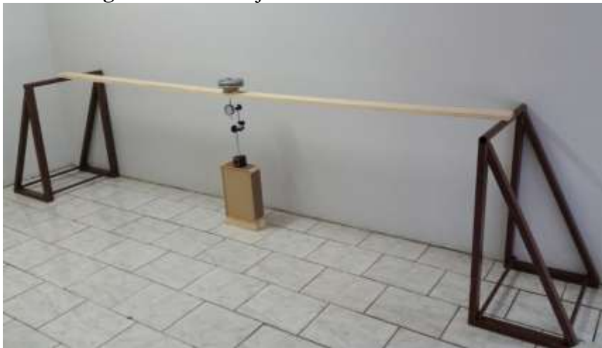
Figura 3.5 – Arranjo do ensaio de flexão estática
