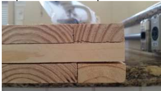
Figura 4.18 – Ruptura na linha de cola do painel P9 testado ao cisalhamento
