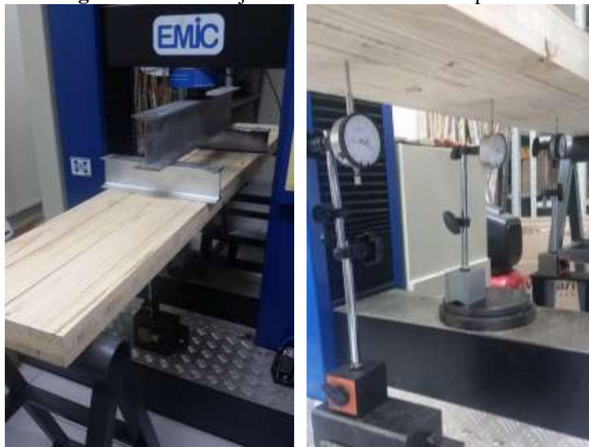
Figura 3.12 – Arranjo do ensaio de flexão dos painéis
