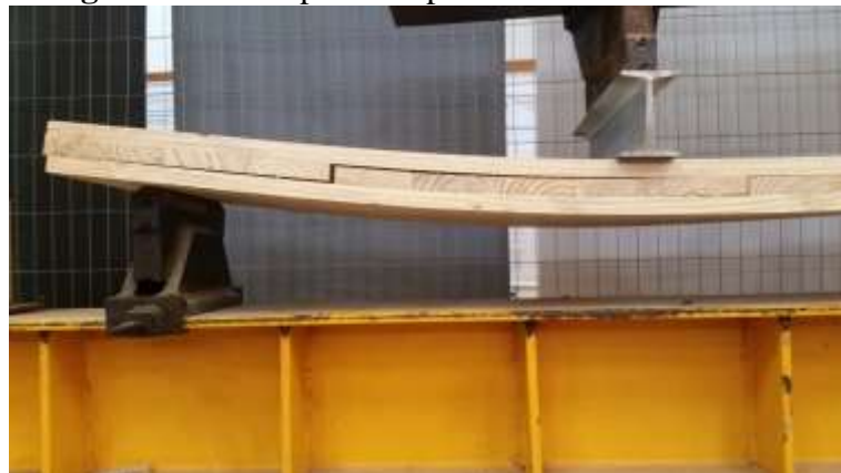
Figura 4.11 – Ruptura do painel P12 testado à flexão
