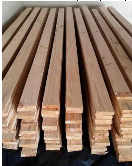
Figura 3.1 – Lamelas de madeira de pinus para a produção de painéis
