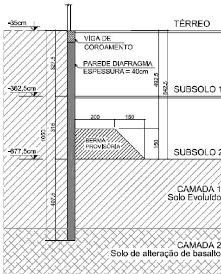
Figura 4.2 – Caso 1: Seção Típica da Estrutura de Contenção.
