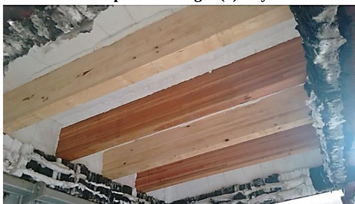
Figura 3.2 – Faces expostas ao fogo: (a) Layout dos ensaios; (b) representação ilustrativa
