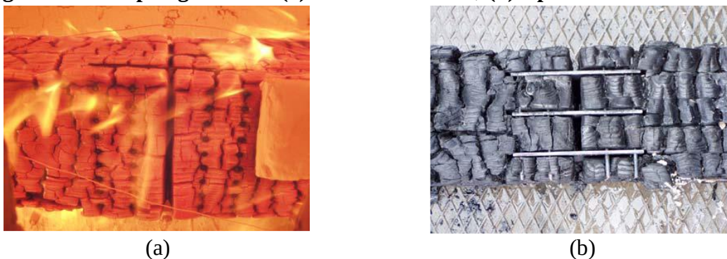
Figura 2.11 – Tipologia D01.1: (a) Durante o ensaio; (b) Após a retirada do forno
