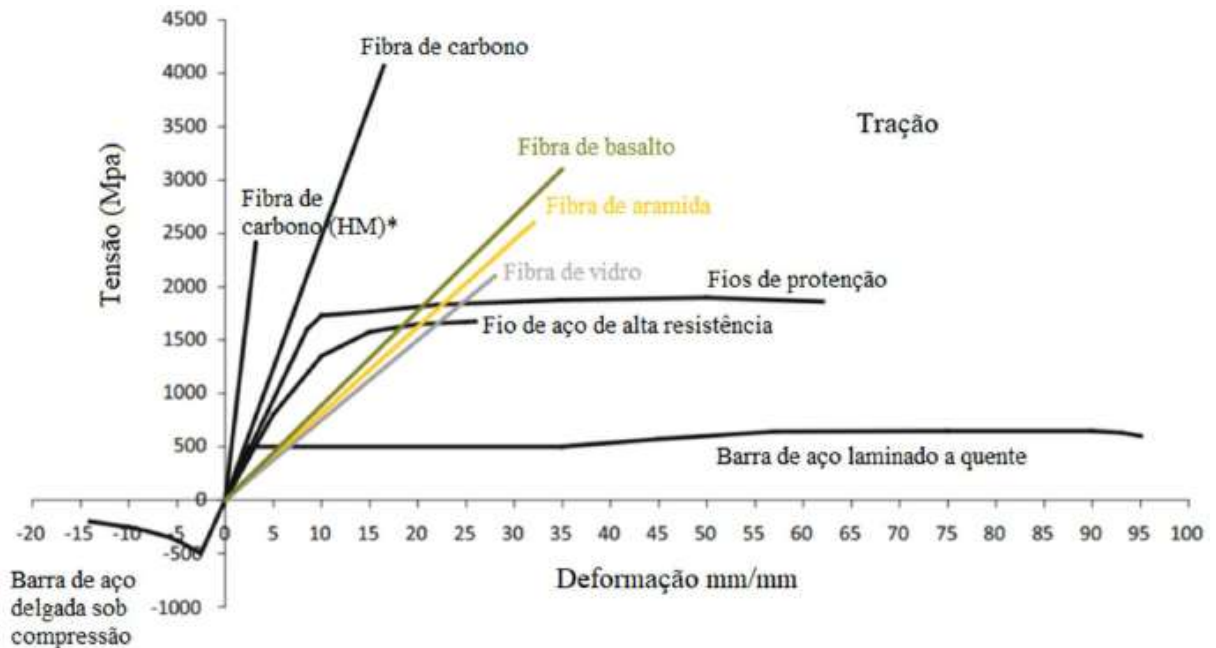
Figura 3.2 – PROPRIEDADES MECÂNICAS DE FIBRAS, CONCRETO E AÇO
