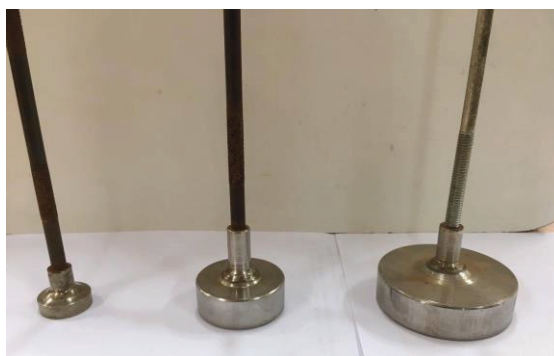
Figura 3.9 – Placas metálicas circulares utilizadas como ancoragens: a) D = 28,50 mm, b) D = 50,80 mm e c) D = 76,20 mm
