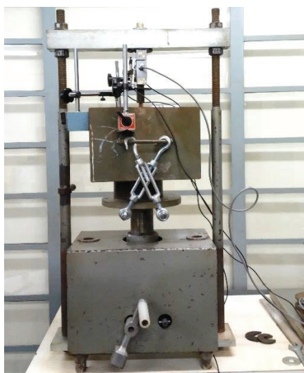
Figura 3.13 – Ensaio de arrancamento em escala reduzida
