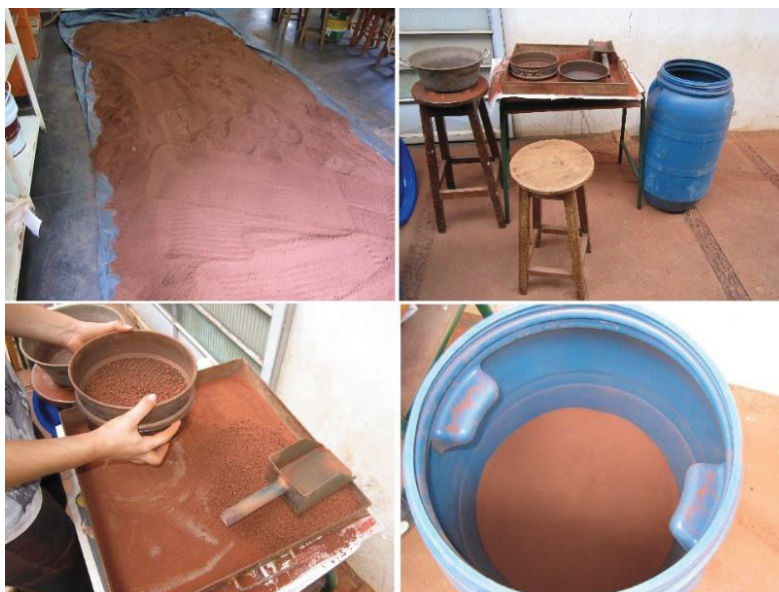
Figura 3.6 – Preparação da amostra de solo
