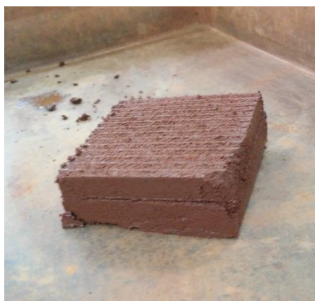
Figura 3.8 – Corpo de prova após o ensaio de cisalhamento direto
