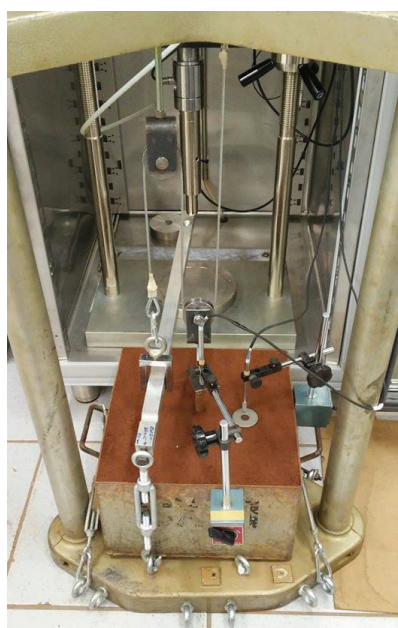
Figura 3.19 – Ensaio de arrancamento dinâmico em modelo reduzido
