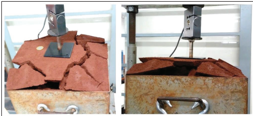
Figura 4.10 – Ruptura na superfície – Condição B: 100% sem sobrecarga
