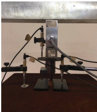
Figura 3.14 – Posição dos sensores LVDT's
