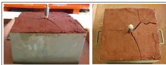
Figura 4.6 – Ruptura na superfície – condição A
