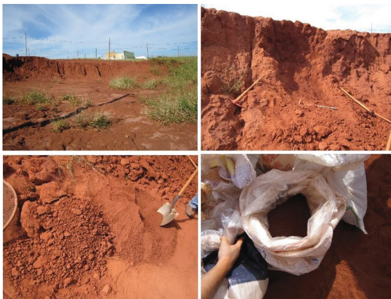
Figura 3.5 – Local e processo de coleta da amostra de solo
