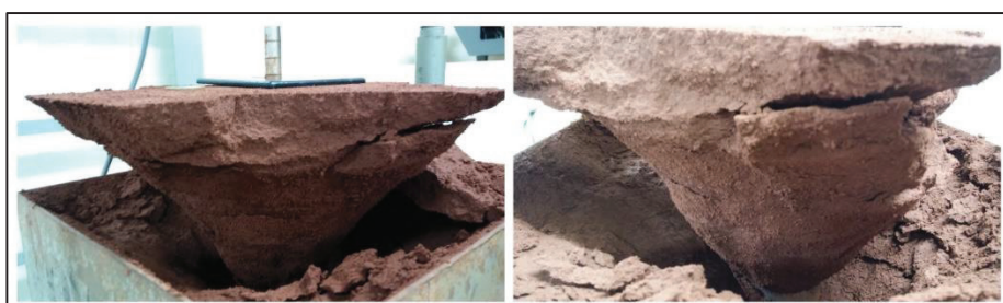
Figura 4.11 – Superfície de Ruptura – Condição B: 100% sem sobrecarga
