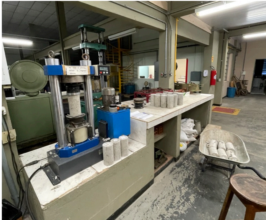
Figura 37 - Prensa hidráulica para resistência a compressão
