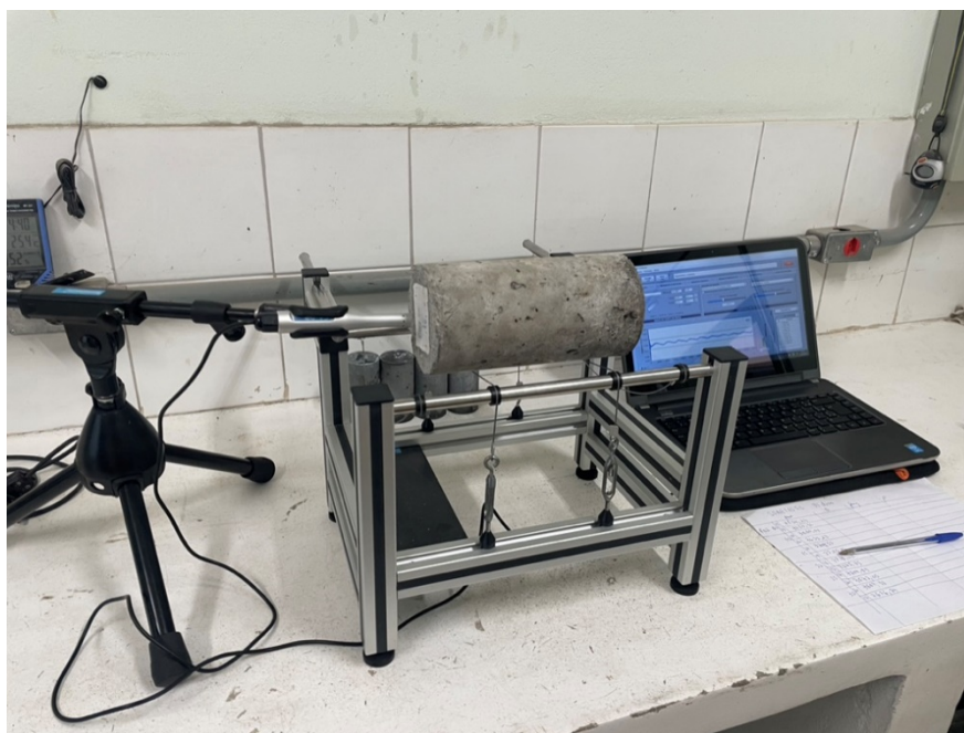
Figura 39 - Realização do módulo de elasticidade
