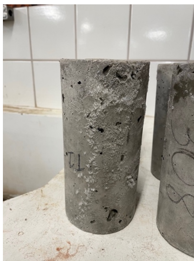
Figura 64 – Inspeção visual traço piloto (Solução de 10% de sulfatos)
