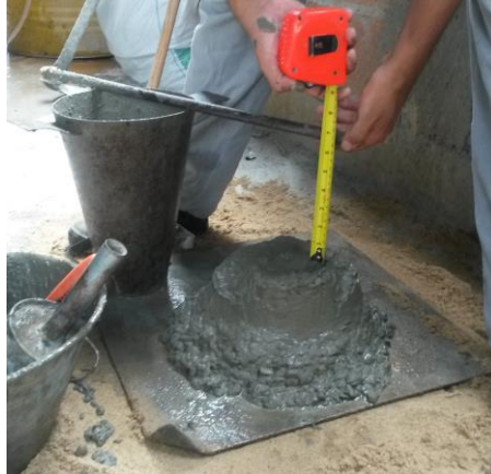
Figura 3.4 – Ensaio de consistência do concreto
