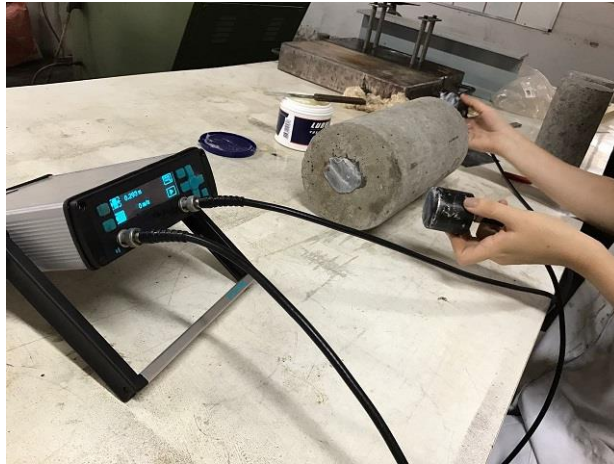
Figura 3.17 – Aplicação de acoplante nas superfícies dos elementos
