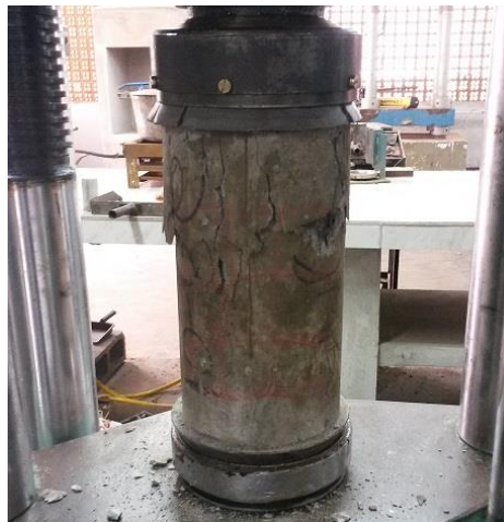
Figura 3.21 – Ensaio de determinação da resistência à compressão
