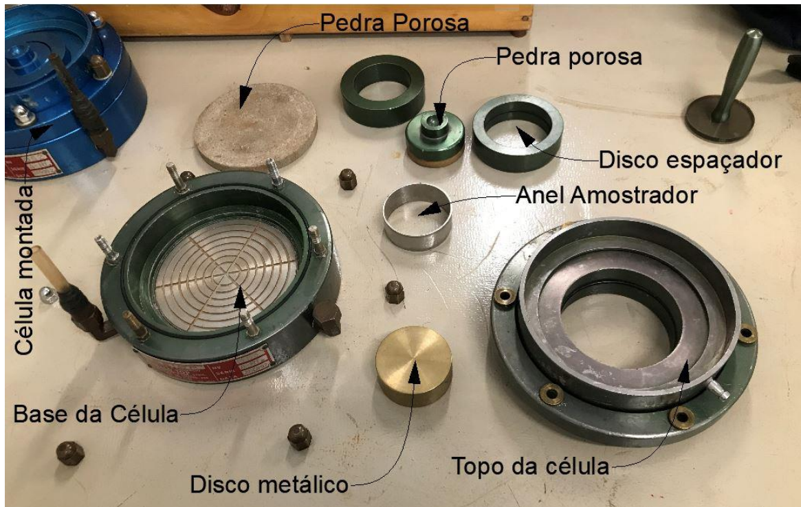
Figura 3.7 - Célula de expansão desmontada
