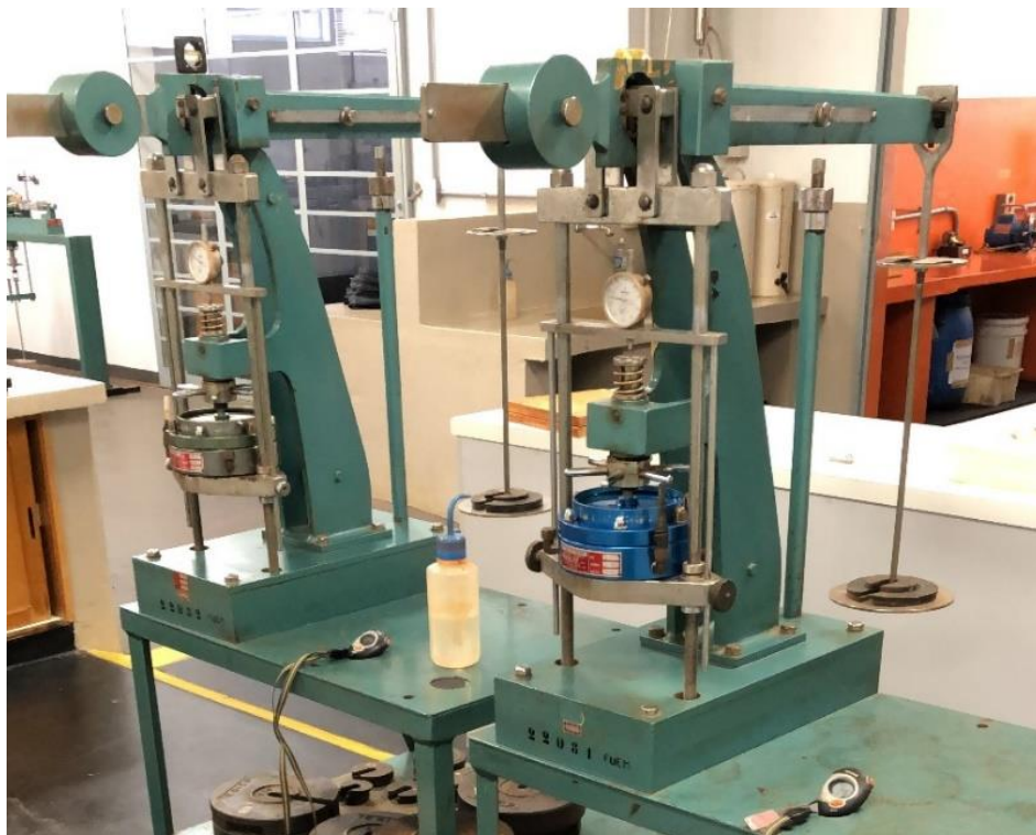
Figura 3.10 - Ensaio de expansão em andamento nas prensas de consolidação
