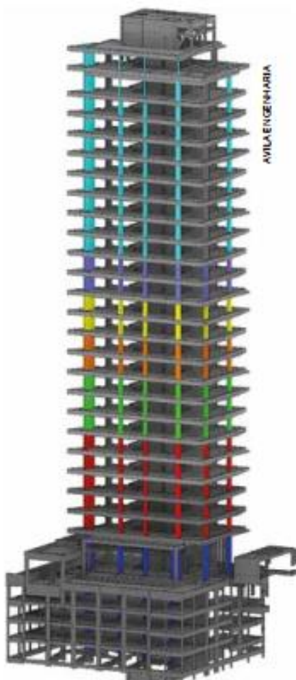
Figura 27 - Ilustração da variação do f_{ck} do concreto ao longo do edifício.
