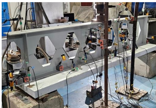
Figura 2.6 – Instrumentação do ensaio de três pontos realizado por Oliveira et al. (2025)
