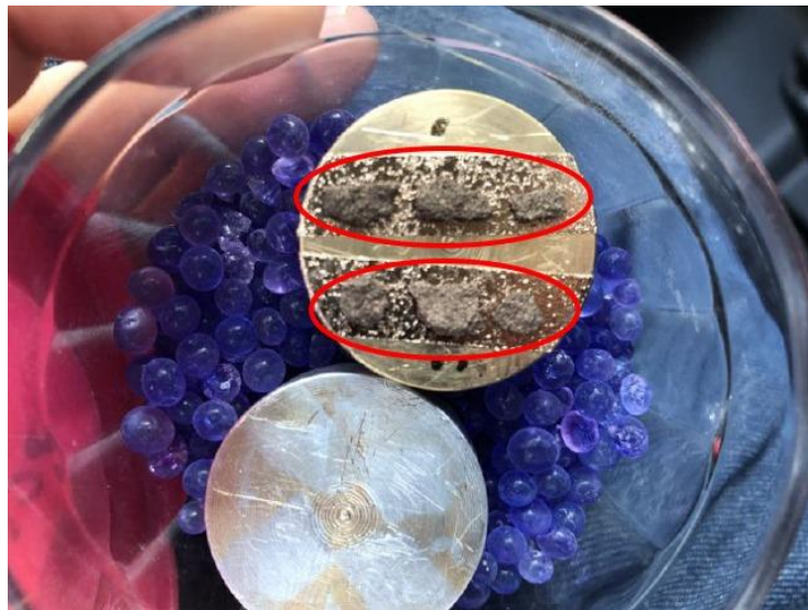
Figura 3.13 - Lascas de solo metalizadas e posicionadas no porta amostra
