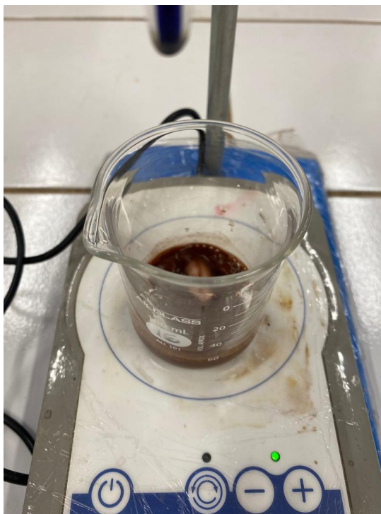
Figura 3.5 - Agitação da solução de solo e água destilada
