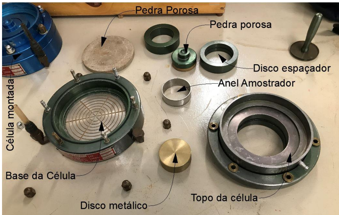
Figura 3.7 - Célula de expansão desmontada
