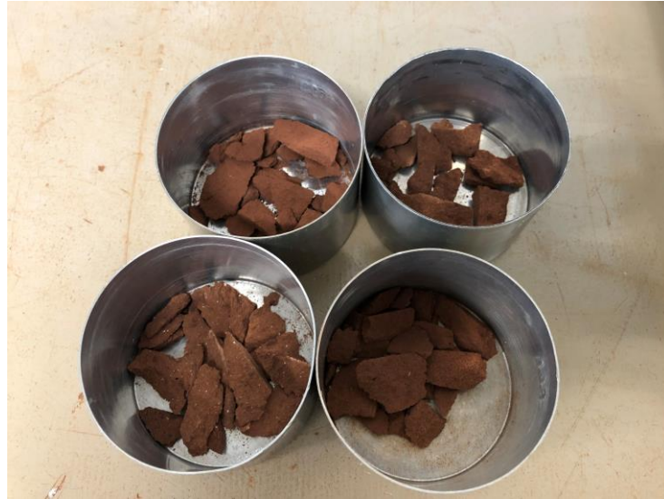
Figura 3.12 - Lascas dos corpos de prova após secagem
