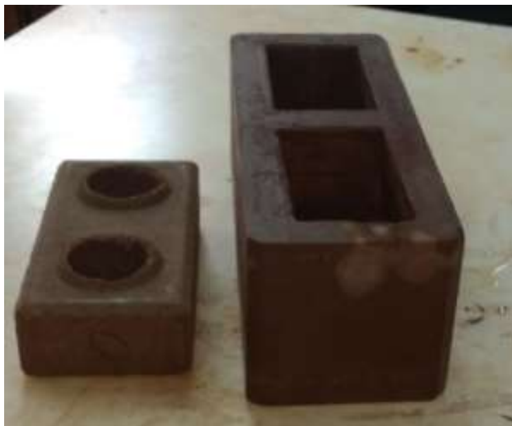
Figura 2 – Exemplo de bloco e tijolo vazados de solo-cimento-RCC
