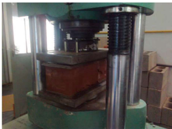
Figura 28 – Rompimento dos blocos
