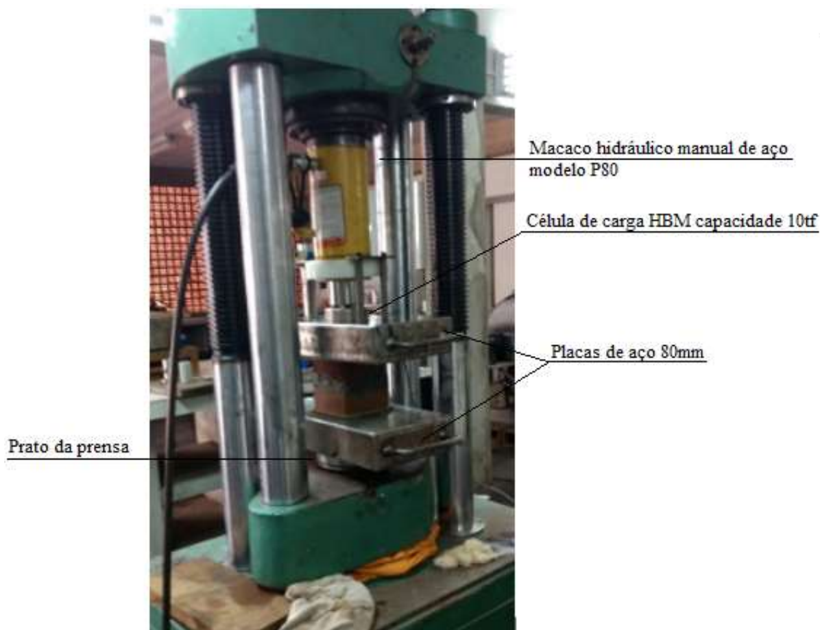
Figura 43 –Esquemática do ensaio de resistência à compressão
