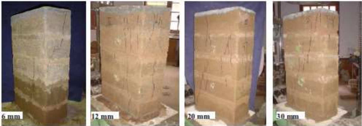
Figura 21 – Modo de ruptura dos prismas com diferentes espessuras de junta de argamassa
