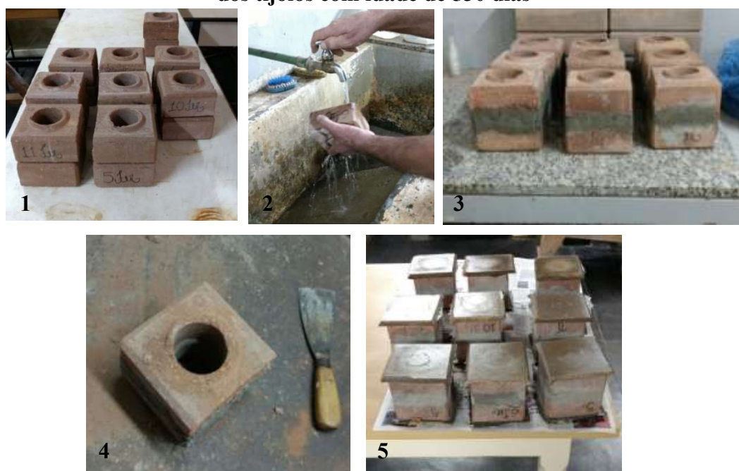
Figura 42 – Preparação dos corpos de prova para o ensaio de resistência à compressão dos tijolos com idade de 530 dias
