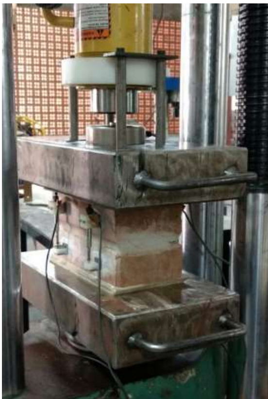
Figura 52 – Esquema de ensaio dos prismas
