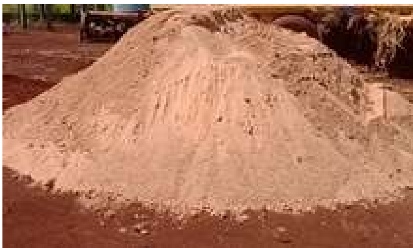
Figura 37 – Amostra de Resíduo da Construção Civil (RCC)
