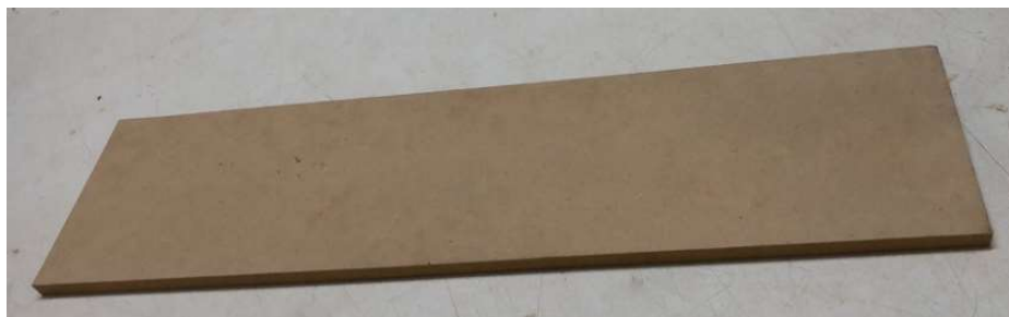
Figura 59 – Chapa de madeira compensada usada como capeamento
