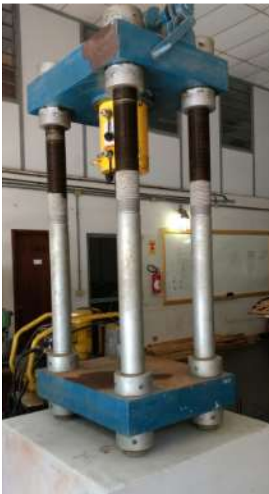
Figura 56 – Pórtico de reação usado para o ensaio das pequenas paredes
