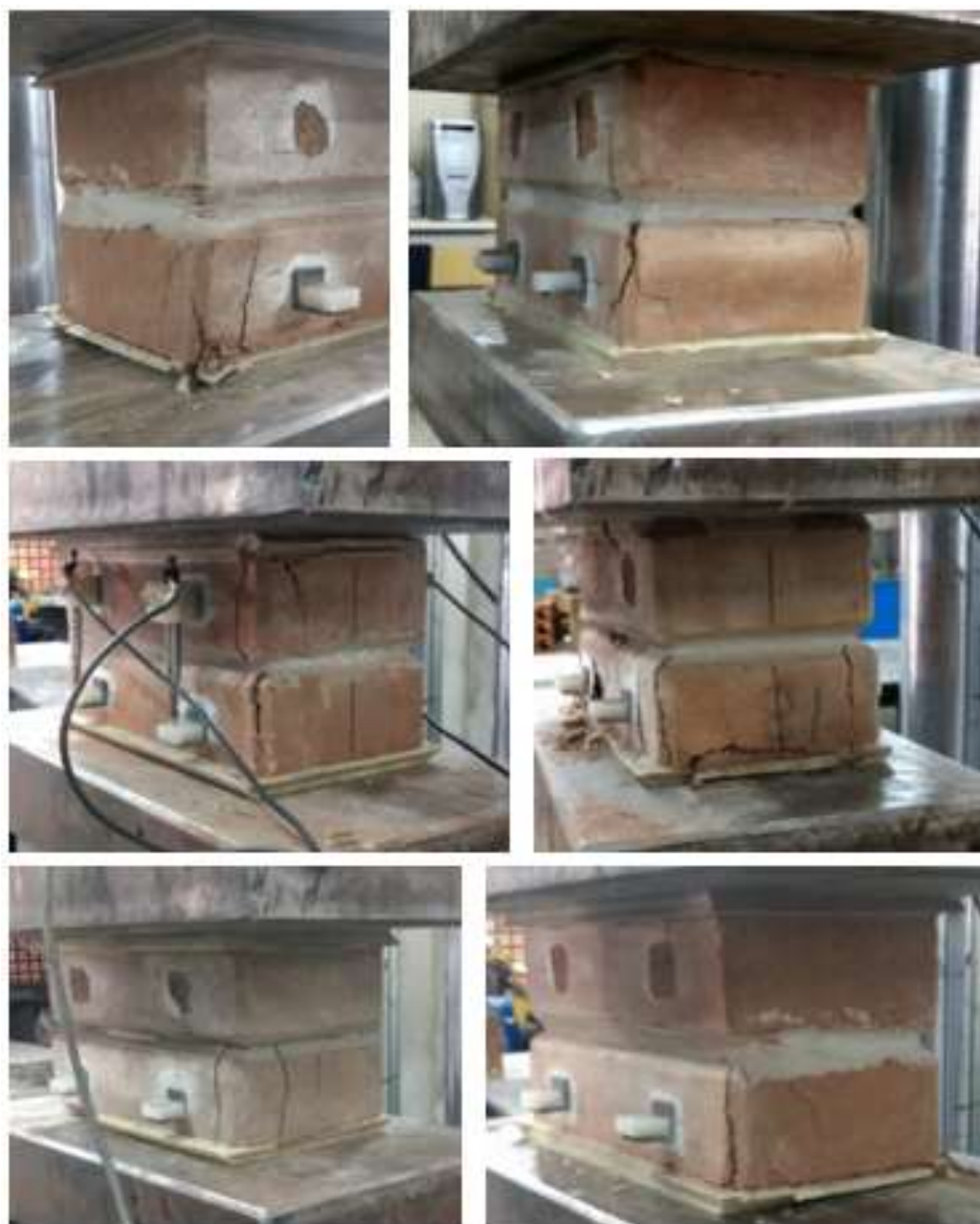
Figura 76 – Fissuras na ruptura dos prismas
