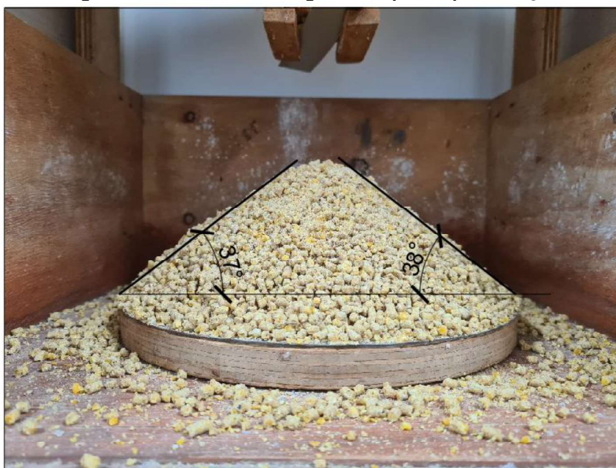
Figura 28 - Resultado do ângulo de repouso para a ração.
