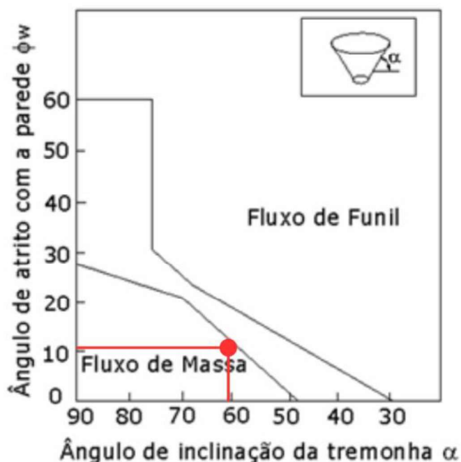
Figura 29 - Tipo de fluxo no silo estudado.
