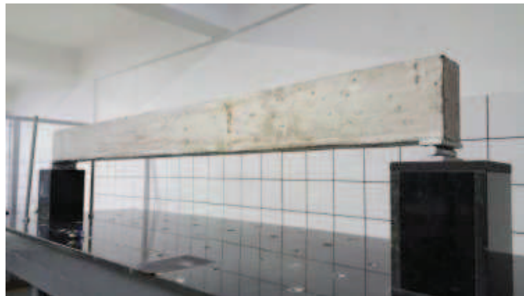
Figura 6. 12- Viga de concreto armado na condição de biapoiada sobre a mesa de reação
