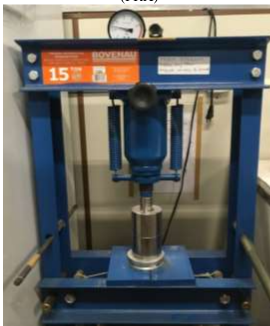
Figura 4.6 - Prensa utilizada na confecção das amostras para o ensaio de fluorescência de raios X (FRX)
