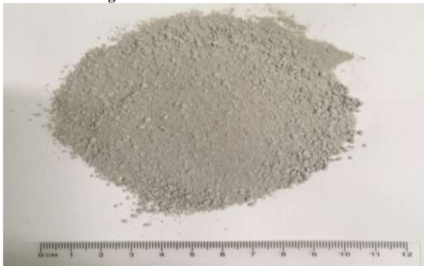
Figura 4.10 - Lama residual de concreto
