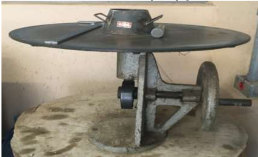
Figura 4.17 – Equipamentos utilizados para o ensaio de índice de consistência: mesa de queda ( flowtable ), molde cônico, soquete e paquímetro
