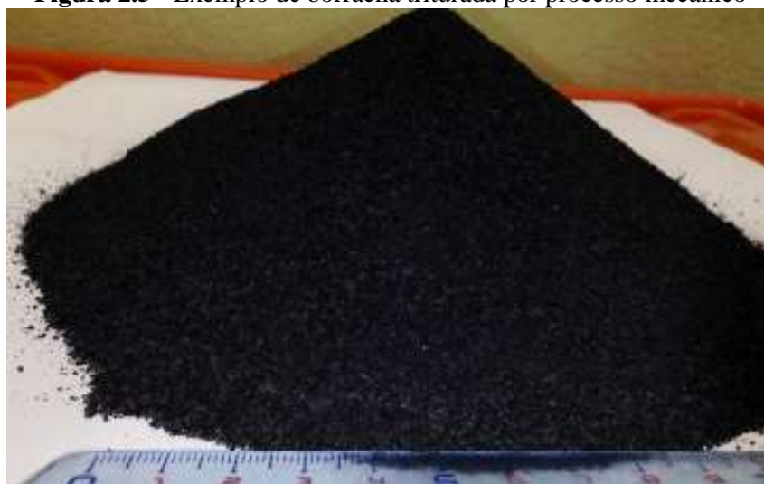
Figura 2.5 - Exemplo de borracha triturada por processo mecânico
