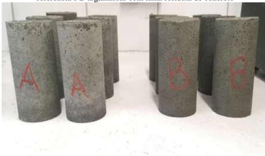
Figura 4.11 - Grupo de argamassas para o ensaio de atividade pozolânica, sendo A argamassa de referência e B argamassas com lama residual de concreto
