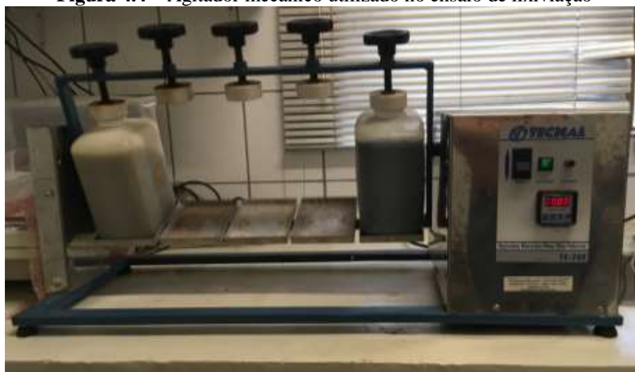
Figura 4.4 – Agitador mecânico utilizado no ensaio de lixiviação
