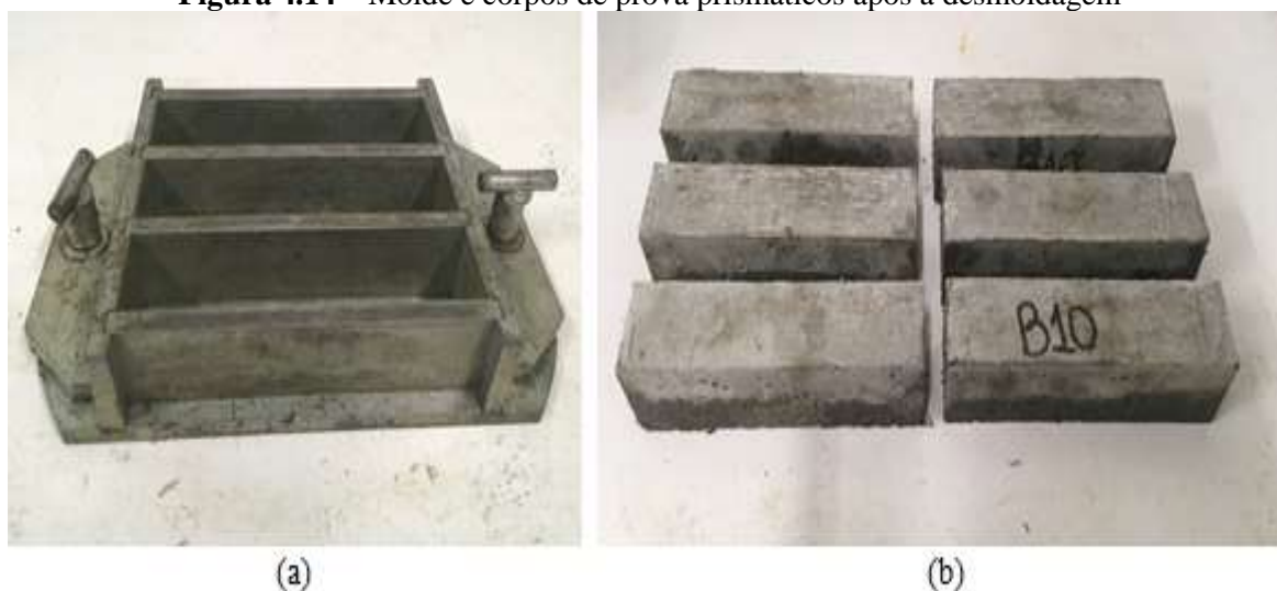
(a) Molde prismático; e (b) corpos de prova após desmoldagem Fonte: A autora (2019)
