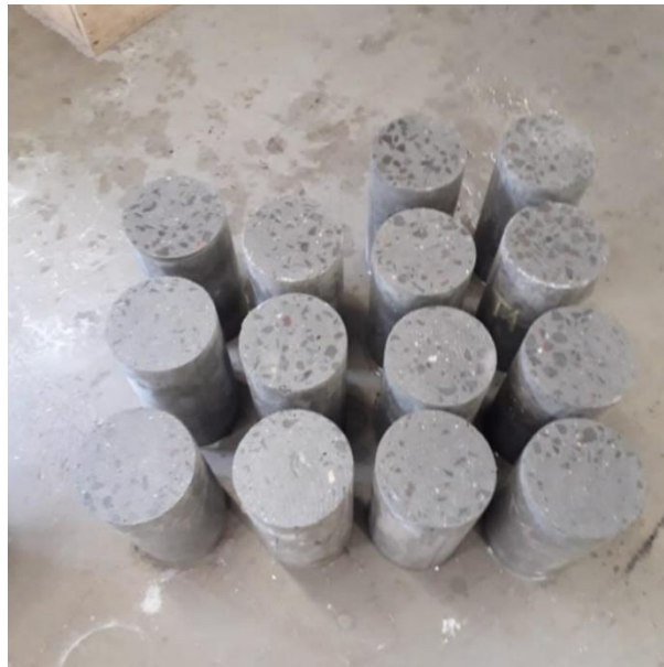
Figura 3.6 - Corpos de prova com superfícies regularizadas
