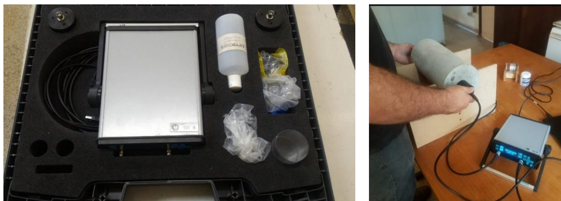
Figura 3.7 - Equipamento Ultrassom (Pundit) e realização do ensaio VPU
