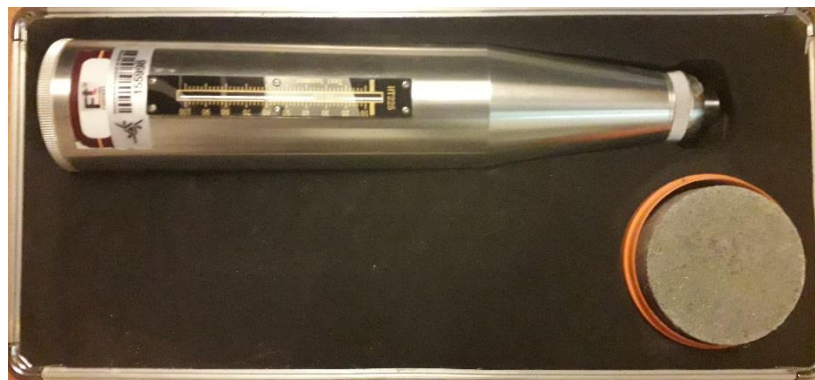
Figura 3.12 – Esclerômetro analógico de impacto Schmidt
