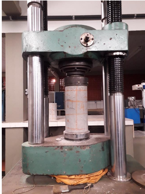
Figura 3.15 - Ensaio de Resistência à compressão axial
