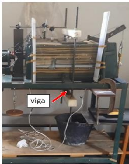
Figura 3.20 – Sistema de reação com viga
