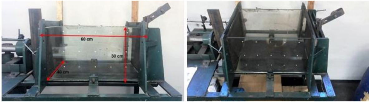
Figura 3.9 – Módulo para ensaio de arrancamento estático
