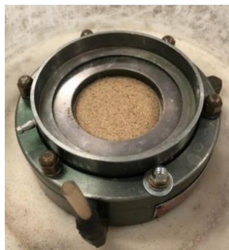
Figura 3.4 – Corpo de prova para ensaio de adensamento oedométrico
