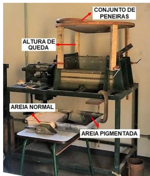
Figura 3.14 – Andamento do ensaio com a adaptação da altura de queda da areia
