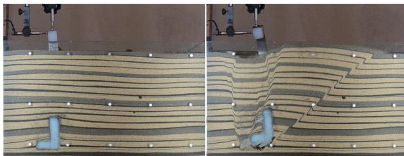
Figura 4.4 – Antes e depois da ruptura para ancoragem 03, D/h = 3
