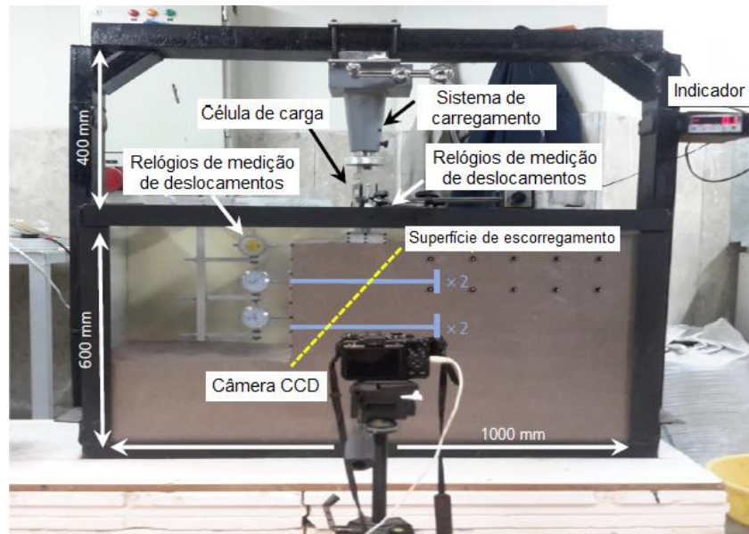
Figura 2.42 – Tanque experimental e câmera CCD
