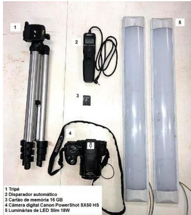
Figura 3.11 – Equipamentos usados para correlação de imagem
