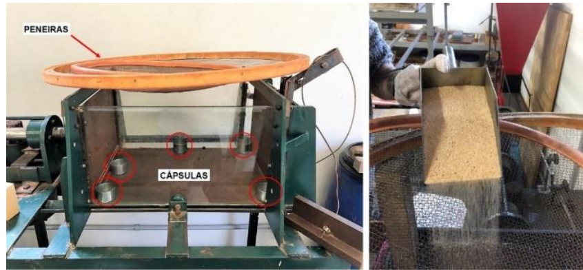
Figura 3.12 – Controle de compactação e pluviamento de areia
