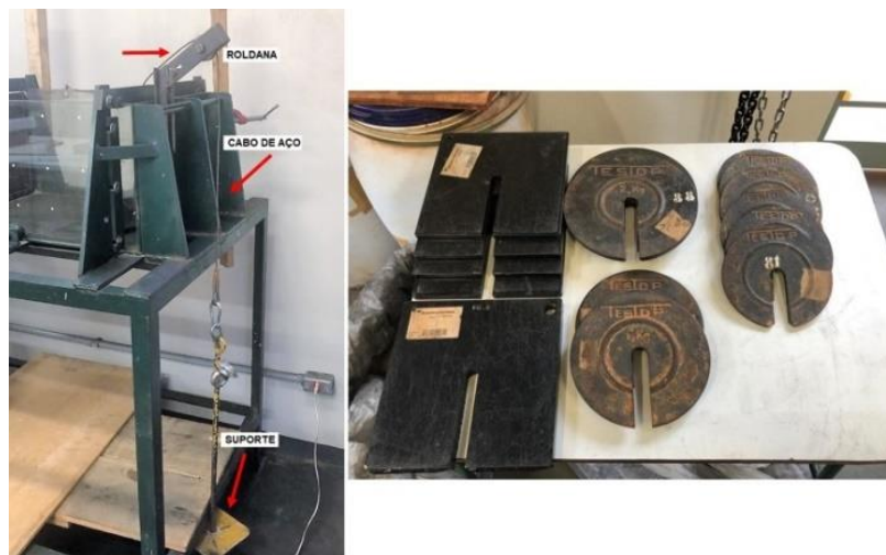
Figura 3.10 – Sistema de carregamento de pesos para ensaio de arrancamento
