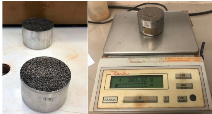
Figura 3.13 – Cápsulas de controle de compactação
