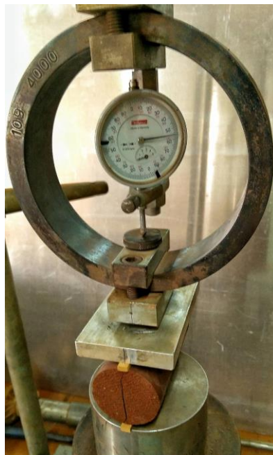
Figura 4-14: Vista da ruptura do corpo de prova
