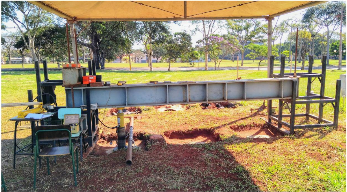
Figura 3-5: Vista frontal utilizada para a prova de carga em placa
