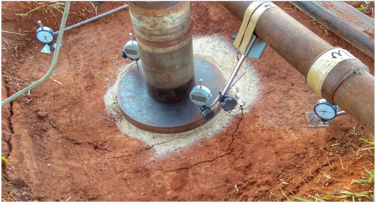
Figura 3-7: Vista frontal dos relógios comparadores na placa e na superfície do solo
