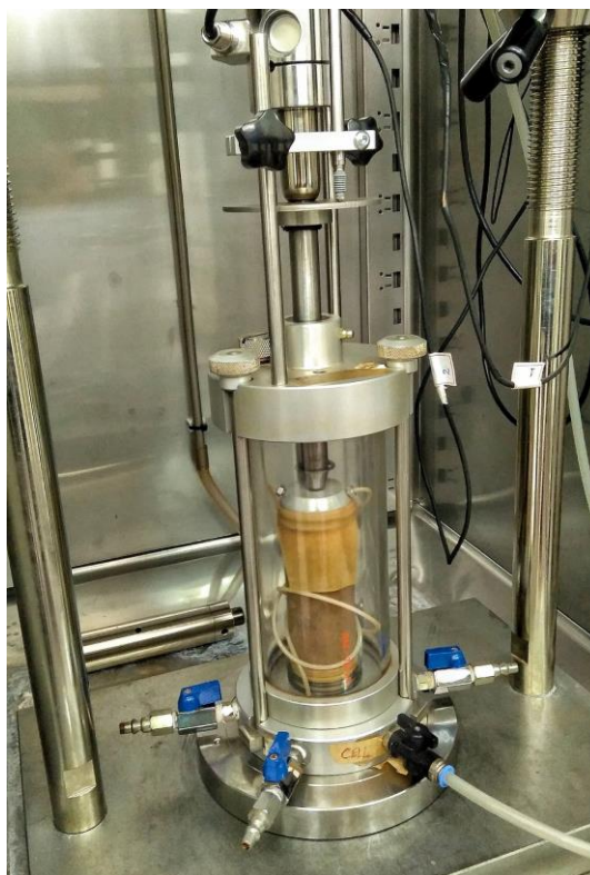
Figura 3-13: Vista frontal do ensaio de módulo de resiliência
