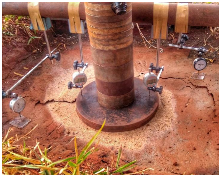
Figura 4-25: Ruptura da sub-base de S_{(48\%)}-P_{(48\%)}-C_{(4\%)} .
