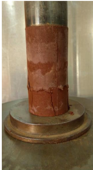
Figura 4-12: Vista frontal da ruptura do corpo de prova
