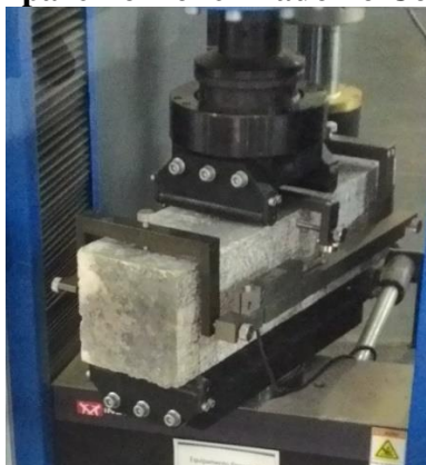
Figura 22 – Aparelho Yoke fixado no Corpo de Prova
