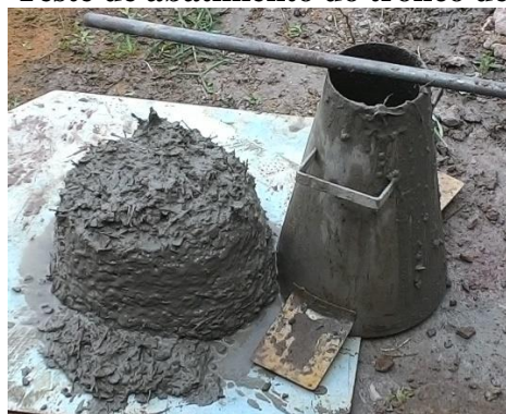
Figura 18 – Teste de abatimento do tronco de cone
