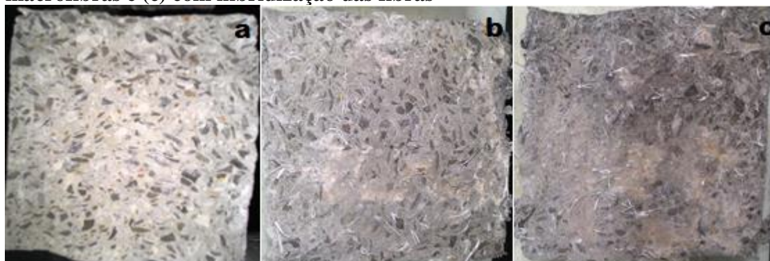
Figura 34 – Seção transversal de ruptura (a) sem fibras (b) somente com macrofibras e (c) com hibridização das fibras
