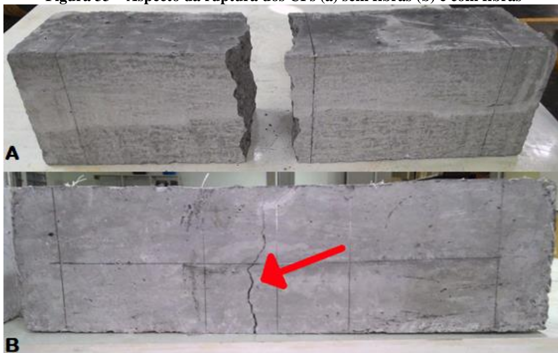
Figura 33 – Aspecto da ruptura dos CPs (a) sem fibras (b) e com fibras
