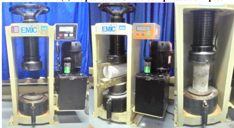
Figura 20 – Fotos (a) Prensa hidráulica (b) Ruptura de CP de compressão diametral e (c) Ruptura de CP de compressão simples
