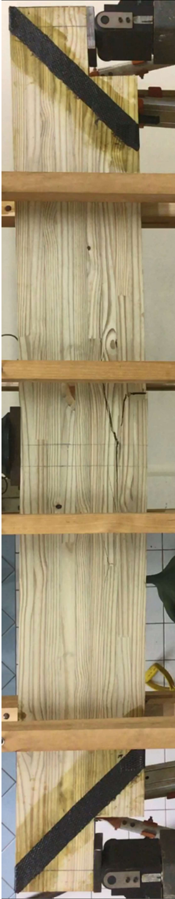
Figura B.8(a) - Ruptura da viga 14: pórtico
