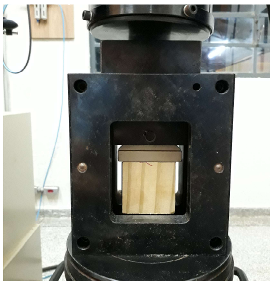
Figura 3.26 – Ensaio de cisalhamento
