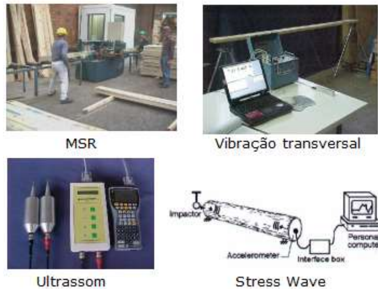
Figura 2.10 – Equipamentos para classificação mecânica
