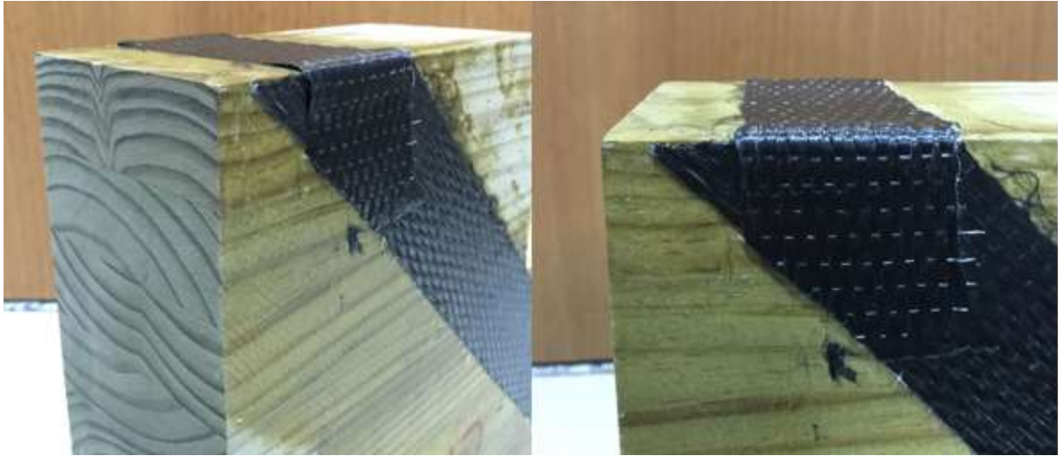
Figura 3.9 – Transpasse das fibras no reforço em 45°
