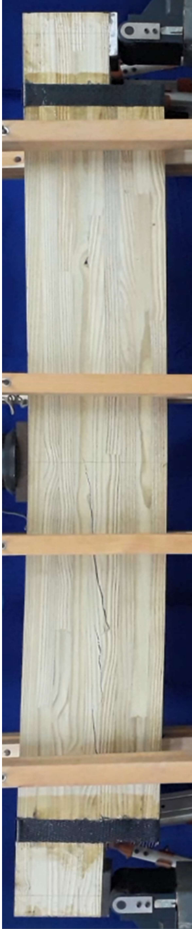
Figura B.6(a) - Ruptura da viga 13: pórtico
