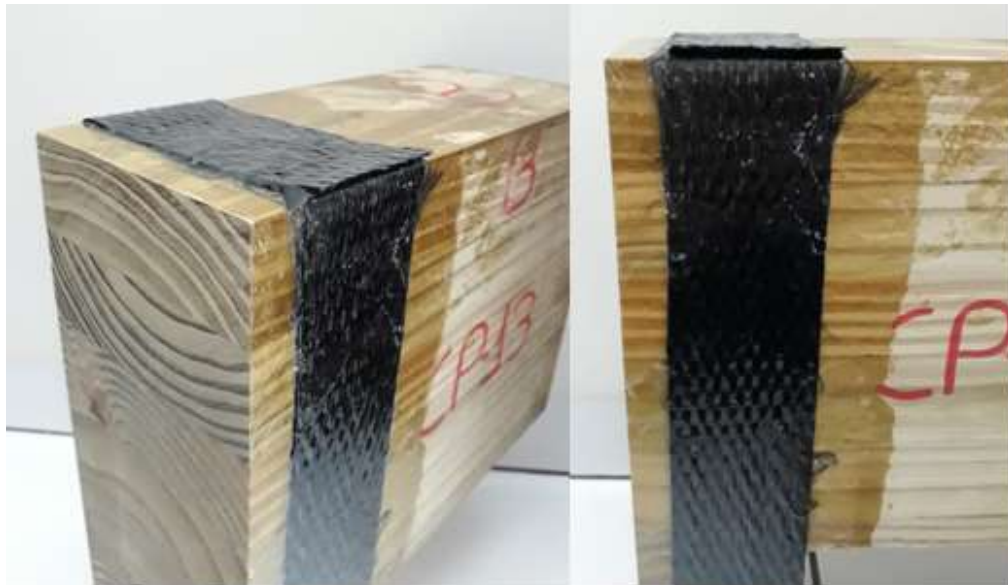
Figura 3.8 – Transpasse das fibras no reforço em 90°
