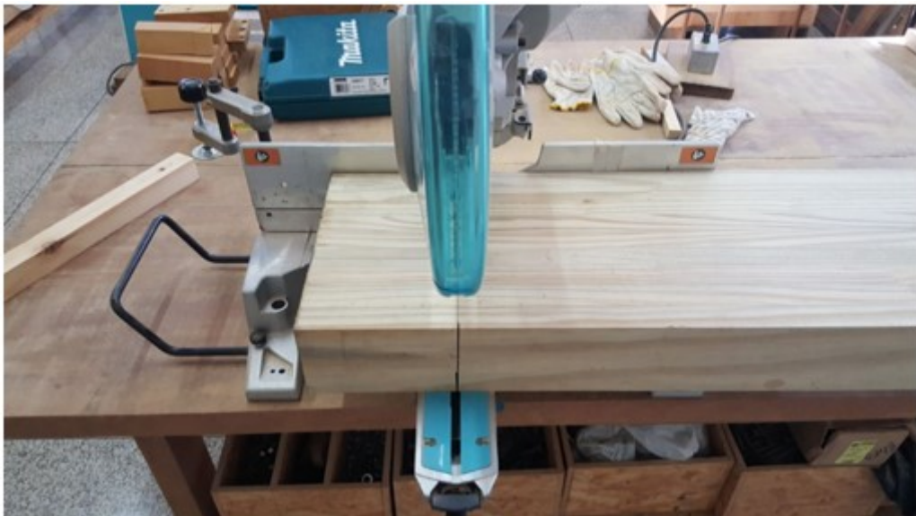
Figura 3.5– Realização dos cortes do entalhe
