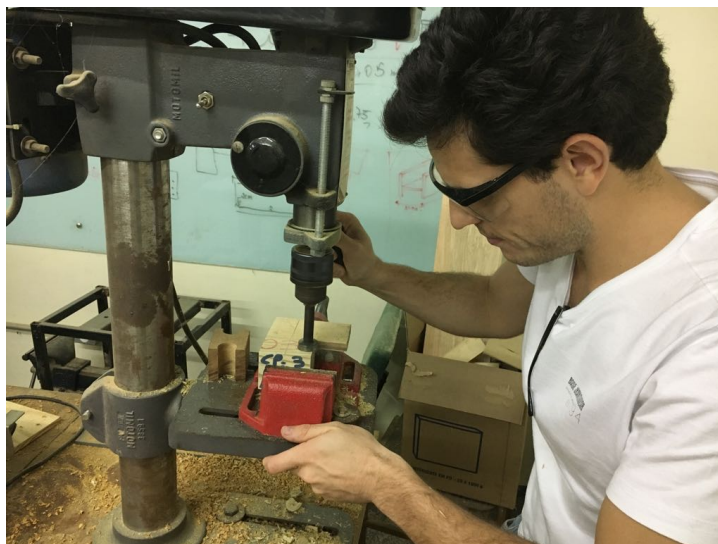
Figura 3.22 – Moldagem dos corpos de prova para ensaio de tração
