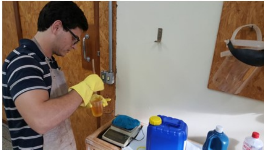
Figura 3.11 – Dosagem da resina
