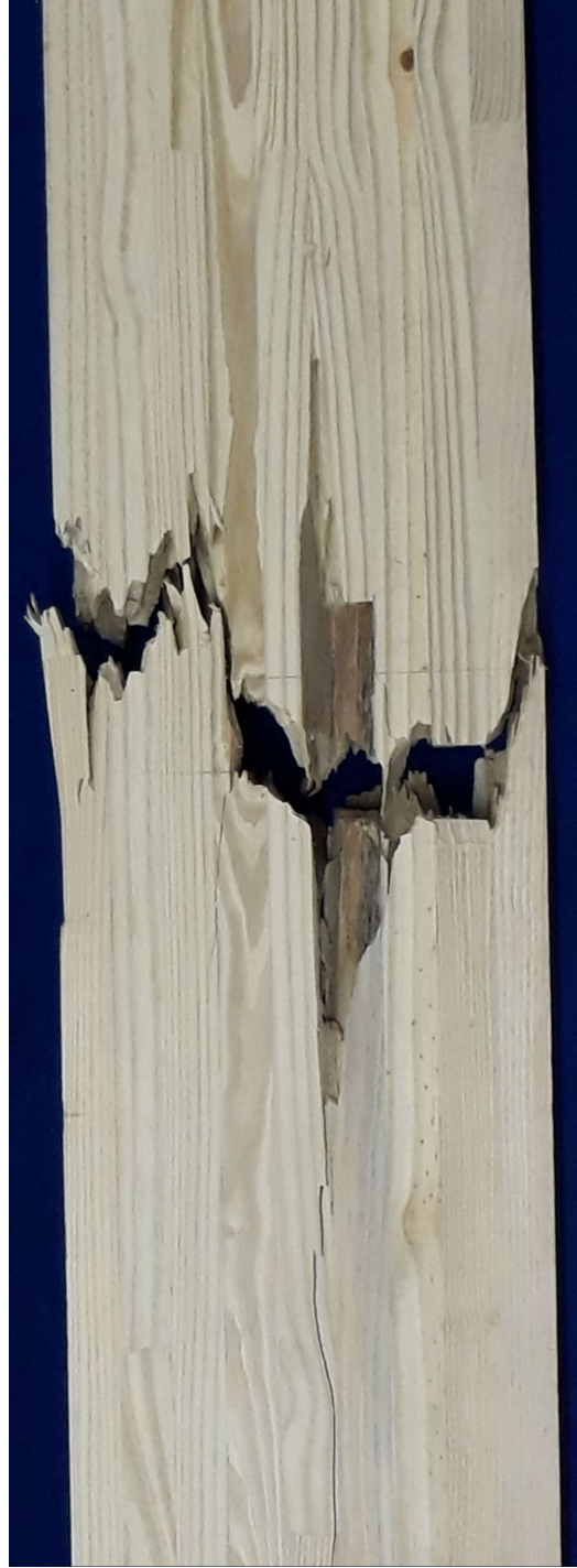
Figura B.9(b) - Ruptura da viga 15: detalhe
