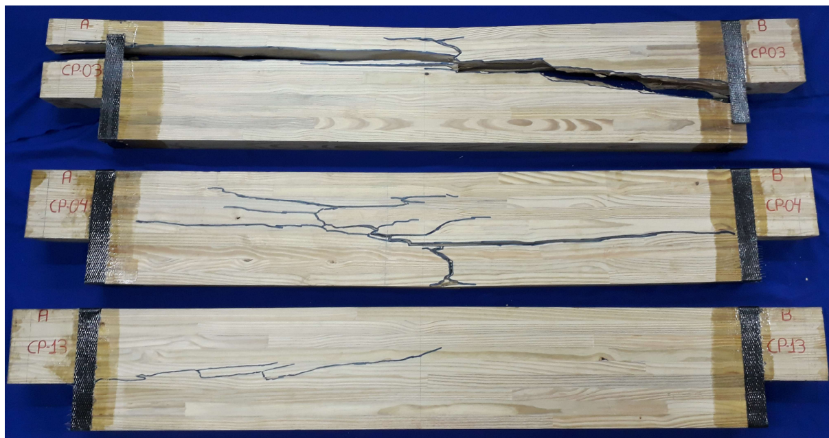
Figura 4.8 – Modo de ruptura das vigas de MLC com entalhe e com reforço em 90°
