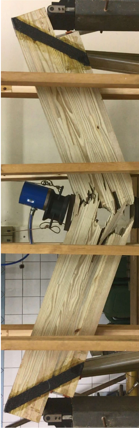
Figura B.9(a) - Ruptura da viga 15: pórtico
