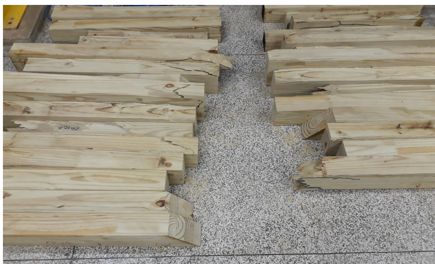
Figura 3.19 – Seleção das peças de madeira para extração dos corpos de prova
