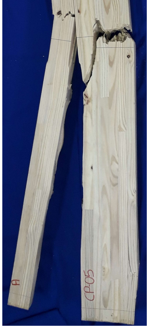
Figura B.10(b) - Ruptura da viga 5: detalhe
