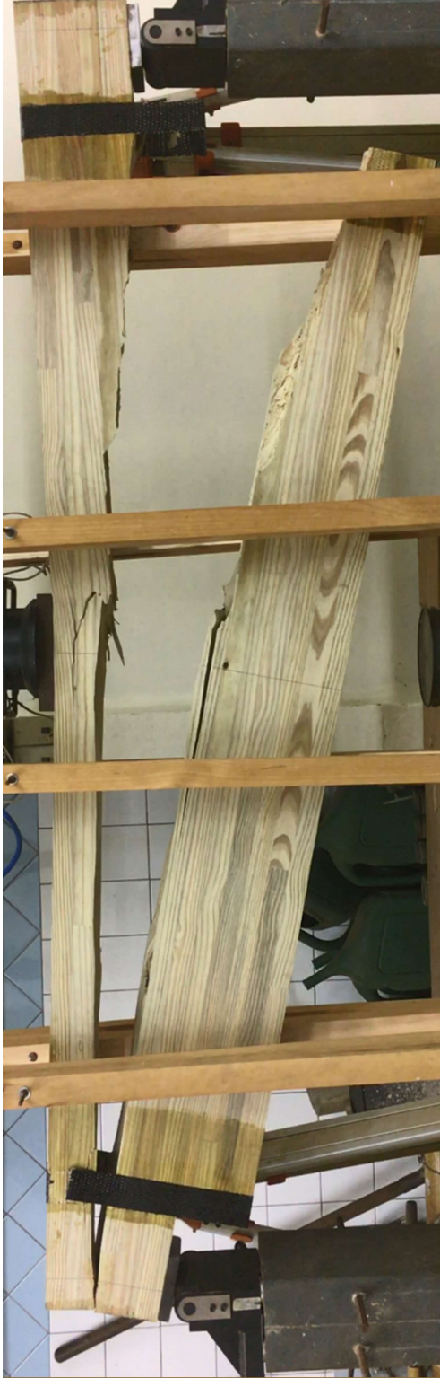
Figura B.4(a) - Ruptura da viga 3: p rtico
