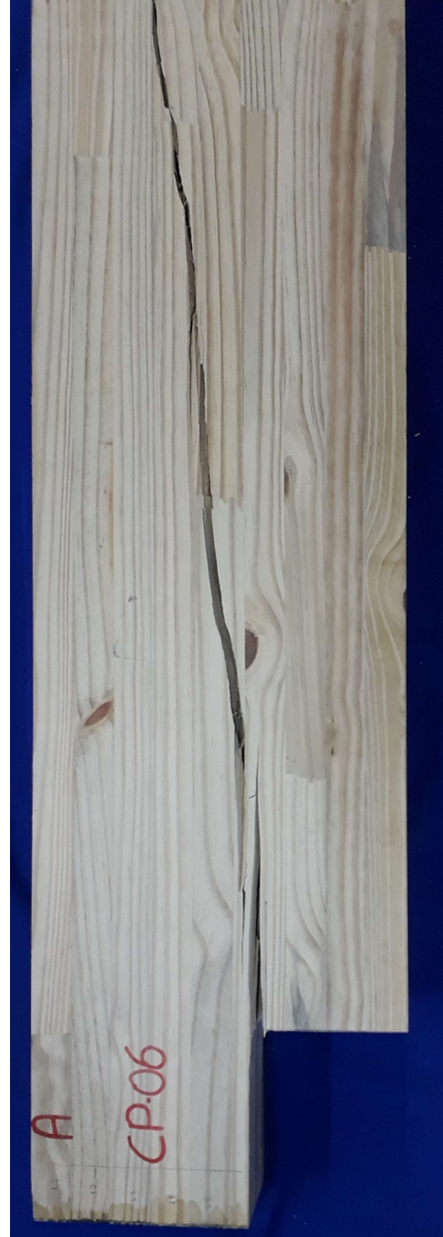
Figura B.2(b) - Ruptura da viga 6: detalhe
