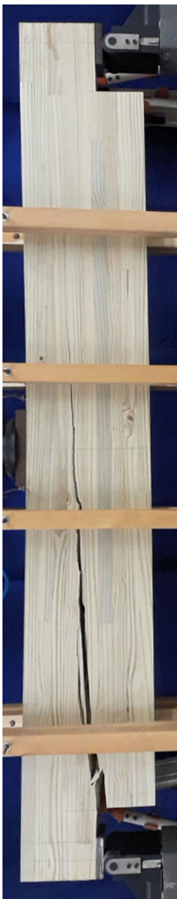
Figura B.3(a) - Ruptura da viga 9: pórtico
