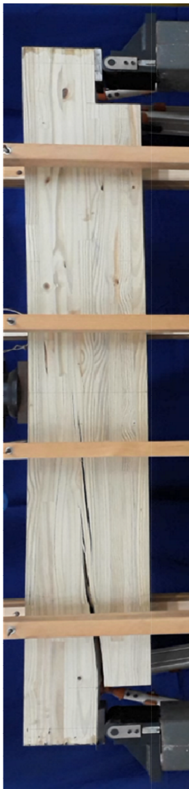
Figura B.1(a) - Ruptura da viga 1: pórtico
