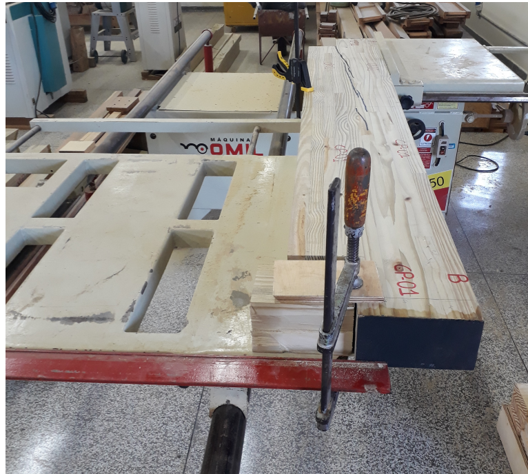
Figura 3.18 – Extração dos corpos de prova para caracterização da MLC
