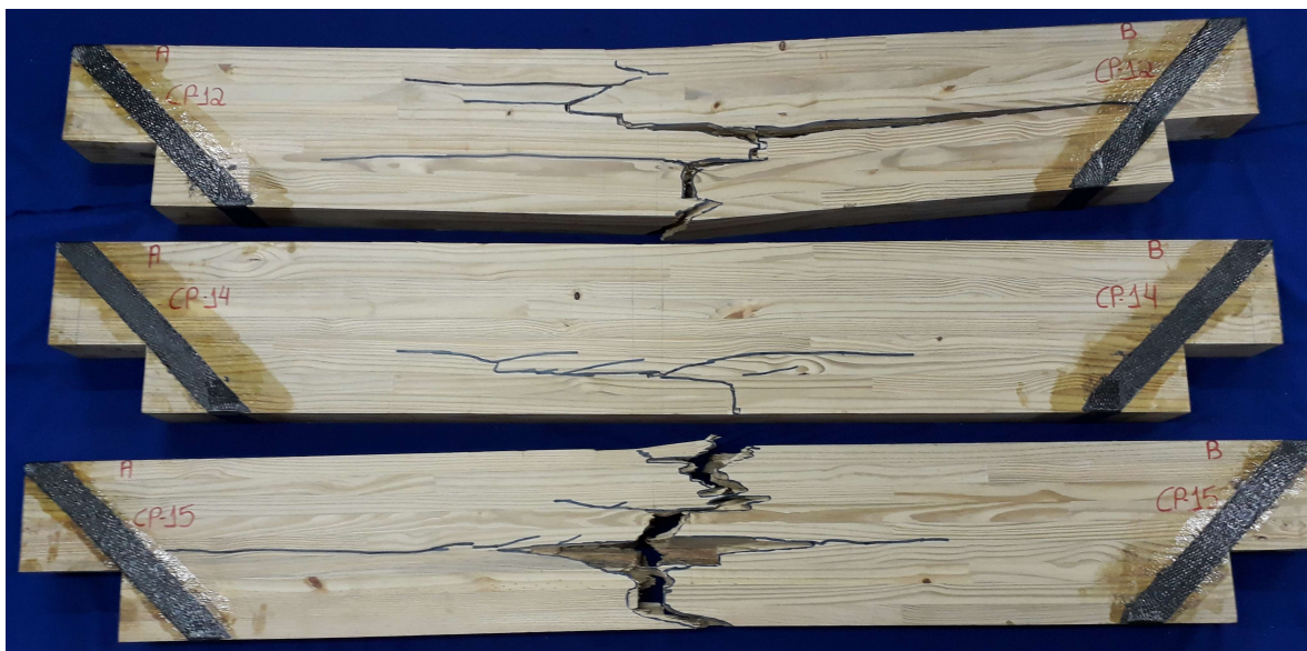
Figura 4.9 – Modo de ruptura das vigas de MLC com entalhe e com reforço em 45°
