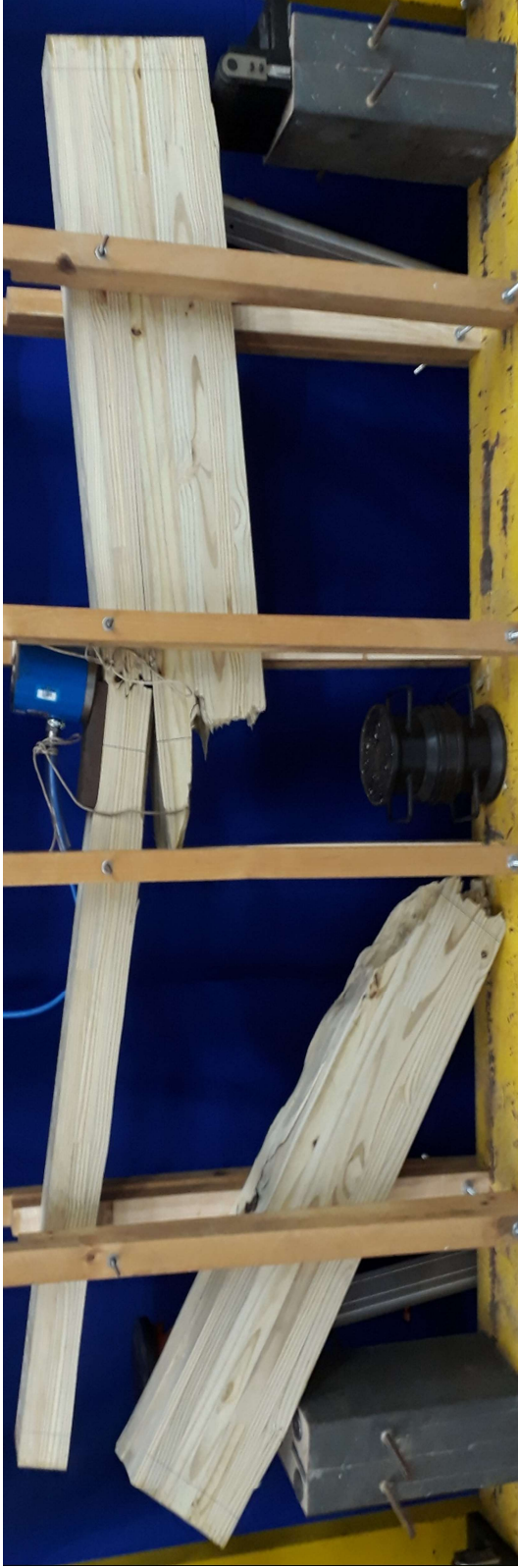
Figura B.10(a) - Ruptura da viga 5: pórtico
