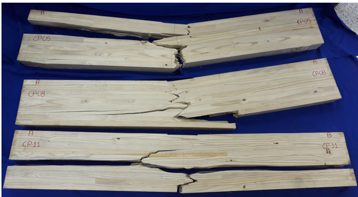
Figura 4.10 – Modo de ruptura das vigas de MLC sem entalhes
