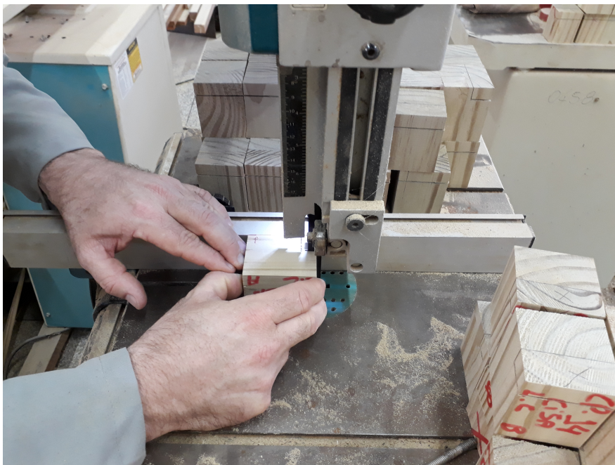
Figura 3.23 – Moldagem dos corpos de prova para ensaio de cisalhamento
