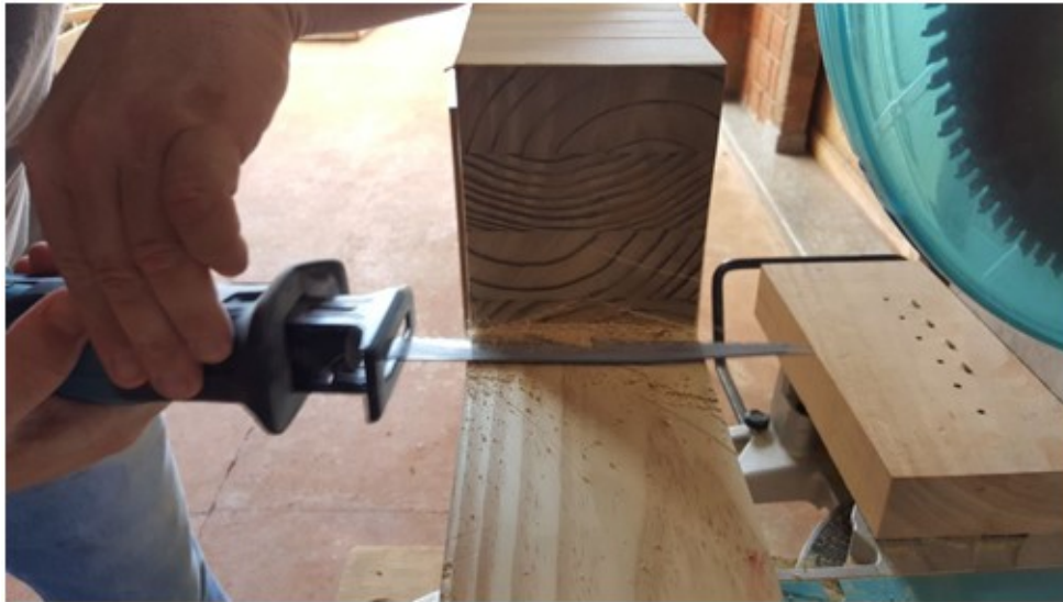
Figura 3.6- Acabamento nos cantos dos entalhes
