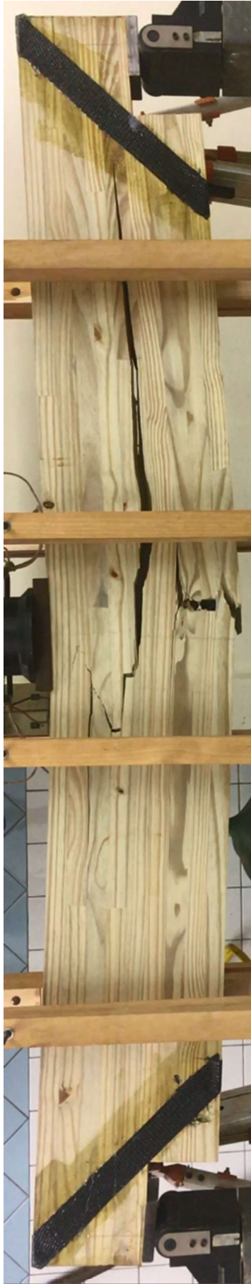
Figura B.7(a) - Ruptura da viga 12: pórtico
