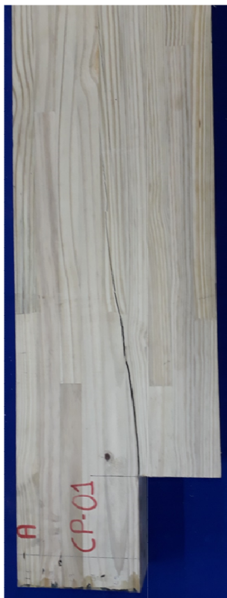
Figura B.1(b) - Ruptura da viga 1: detalhe
