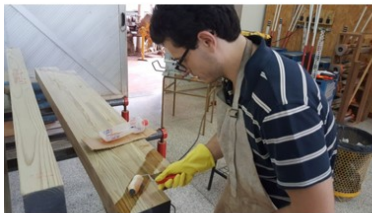
Figura 3.12 – Aplicação da resina primer
