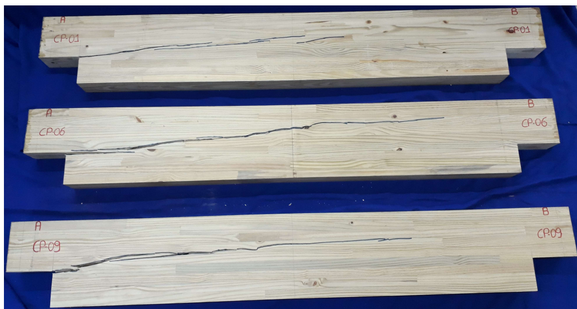
Figura 4.7– Modo de ruptura nas vigas de MLC com entalhe e sem reforço
