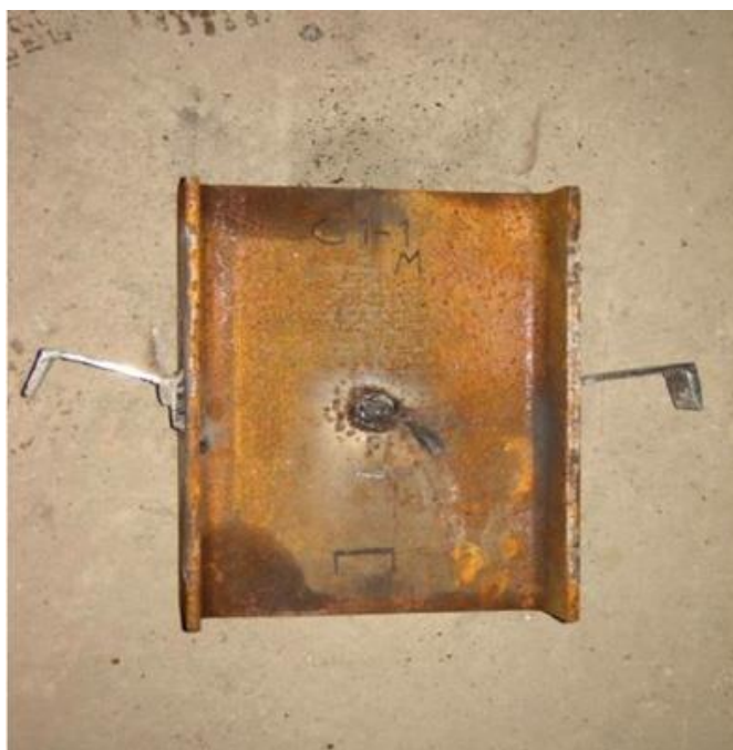
Figura 2.12: Amostra submetida a cisalhamento direto, sem ruptura do conector U
