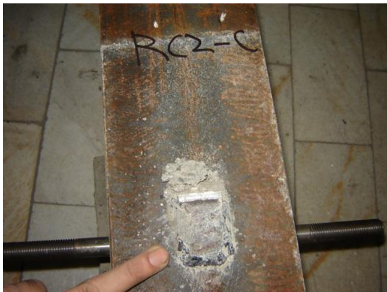
Figura 2.11: Amostra submetida a cisalhamento direto, com ruptura do conector U
