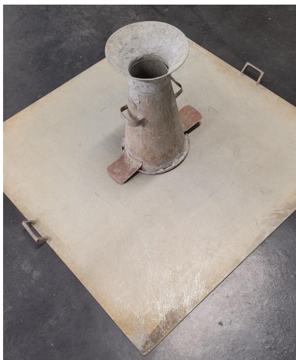
Figura 3.7: Equipamento utilizado no ensaio de slump flow
