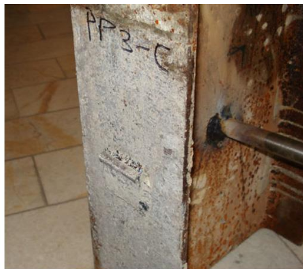
(b) Marca de rompimento do conector no perfil de aço
