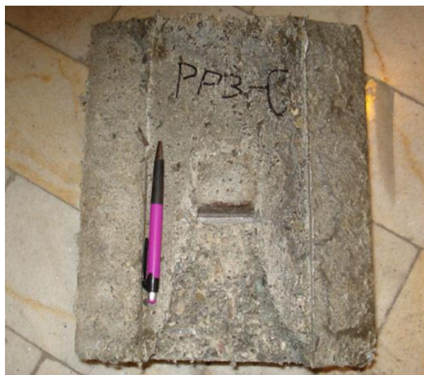
(a) Parte do conector embutida no bloco
