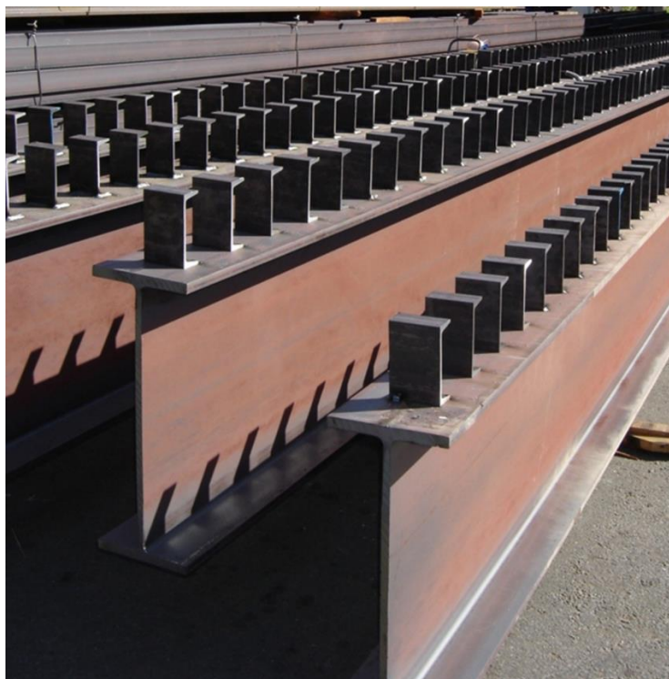
Figura 2.7: Perfis de aço com conectores U soldados na mesa superior
