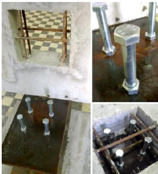
Figura 2.22: Montagem dos espécimes de Pavlović et al. (2013)
