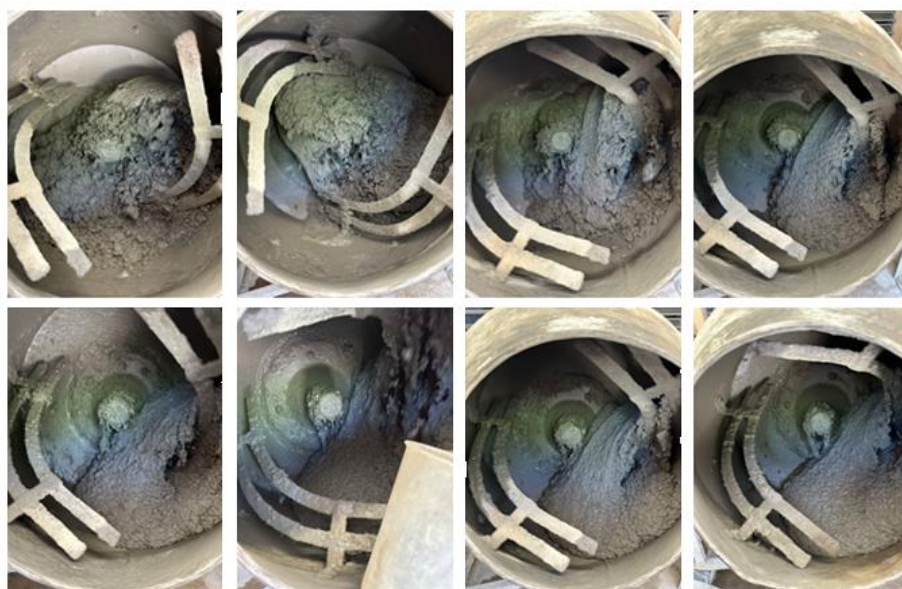
Figura 3.6: Evolução da trabalhabilidade e homogeneidade do concreto
