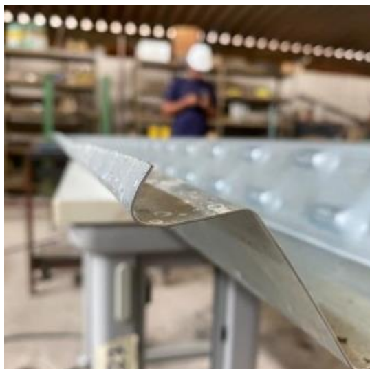
Figura 5.11: Aba na extremidade do steel deck
