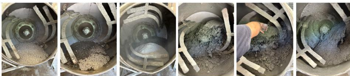
Figura 3.5: Aplicação dos materiais conforme ordem preestabelecida
