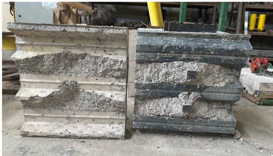
Figura 6.8: Ruptura por cone de cisalhamento em blocos com steel decking
