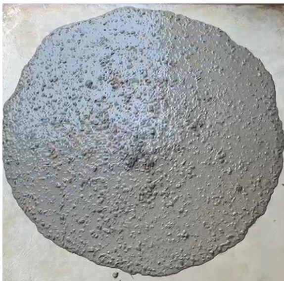
Figura 3.8: Espalhamento do concreto no ensaio de slump flow
