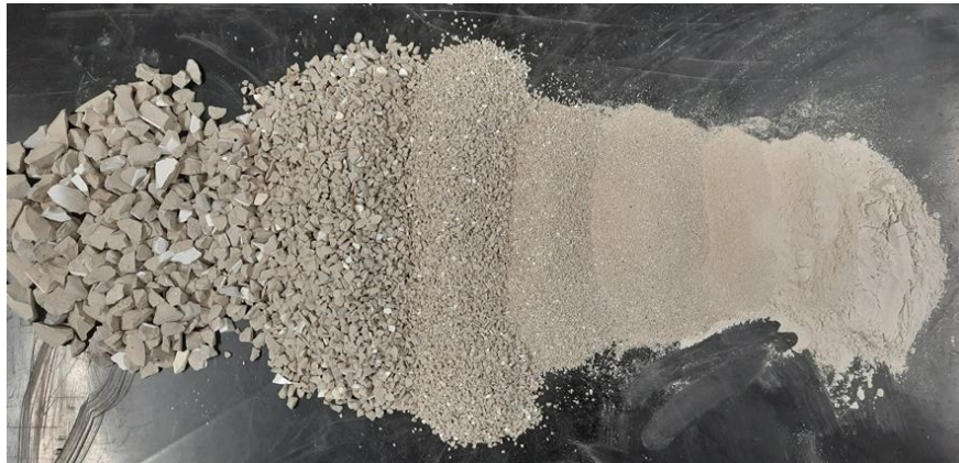
Figura 3.1: Material reciclado assim como recebido, organizado por tamanho de grãos
