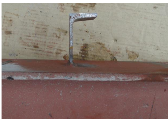
Figura 2.8: Conectores do tipo (a) L ou angular, e (b) U
