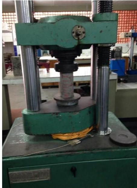
Para a determinação do módulo de elasticidade dos materiais foi utilizada a metodologia indicada na ABNT NBR 8522 (2017). Os ensaios, foram realizados utilizando-se o equipamento Instron EMIC 23-600, como é mostrado na Figura 3.18.
