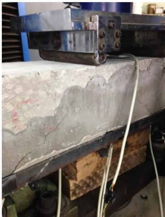
Observa-se que a formação da fissura se dá na parte limítrofe entre a cantoneira e o substrato de transição, horizontalmente e depois parte para o centro da vigota inclinada. As fissuras são espelhadas, evidenciando o bom comportamento do caminho da carga de forma simétrica.
