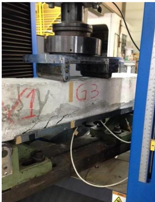
Nota-se na figura fissuras de cisalhamento com o modo de ruína por desprendimento da extremidade do reforço.
