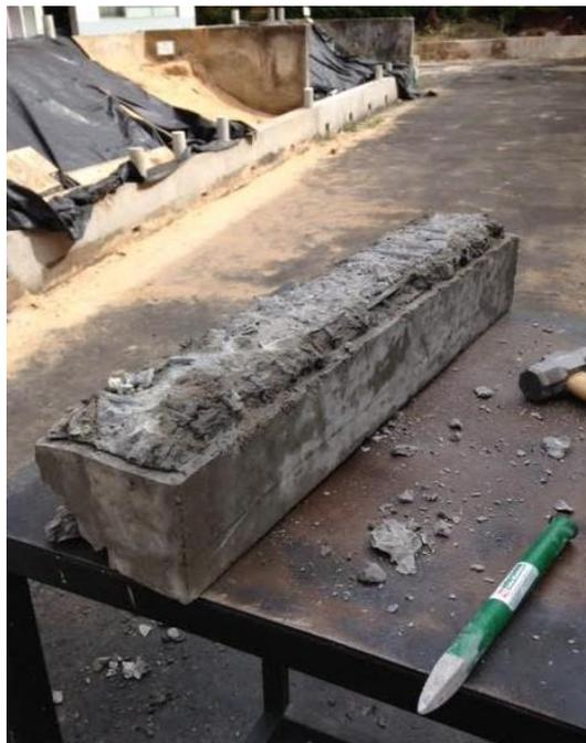
Na Figura 3.24 tem-se o aspecto da vigota após a remoção do concreto do banzo tracionado.
