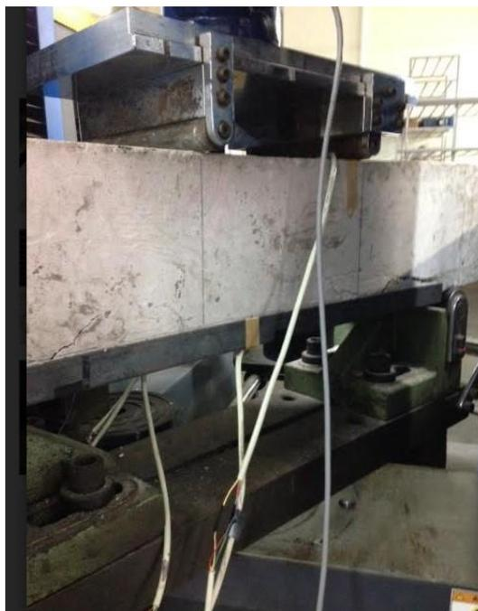
Ressalta-se aqui a fissura na extremidade da vigota, que se inicia logo após a término do perfil e propaga-se para o centro da elemento, inclinada. Fissura essa típica de peeling de cisalhamento, *shear peeling*.
