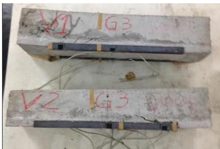
Observa-se em V1, as fissuras inclinadas formadas no início do perfil metálico e dirigindo-se para o centro. As fissuras tem abertura avantajada, com status de rachadura e são
