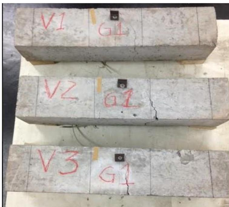
Observa-se que a vigota V1 tem uma fissura de flexão, ainda que diminuta e modo de ruína por escoamento da armadura positiva.
