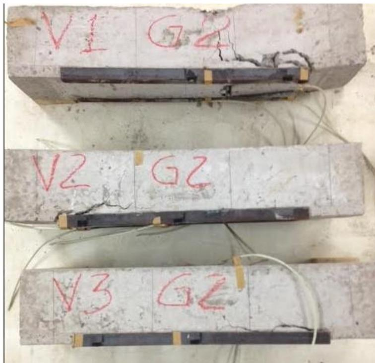
Com base na foto, observa-se que para V1 o estado de fissuração já está avançado, caracterizando a manifestação já como rachadura. Esta propaga-se verticalmente e depois horizontalmente, partindo da extremidade do perfil e na porção central ela torna-se vertical.
