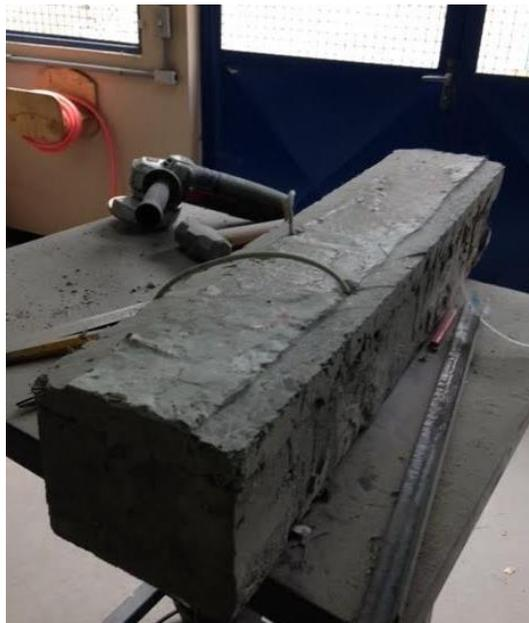
A limpeza da superfície foi realizada com jato de ar comprimido e acetona.
