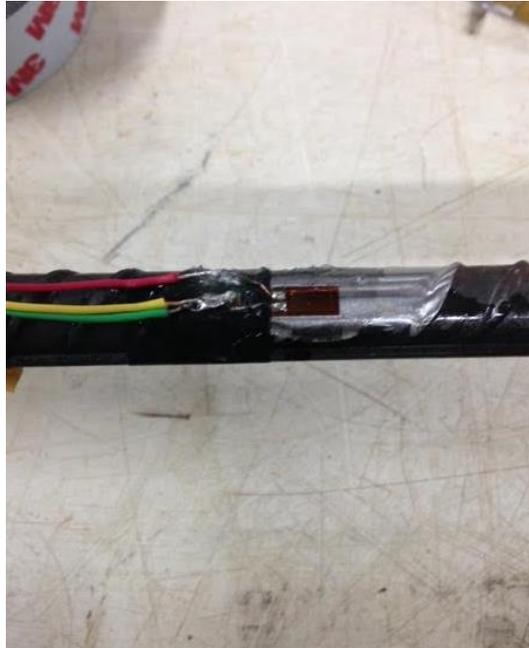
**Figura F5 – Extensômetro colado e soldado – Perfil ASTM A36**
