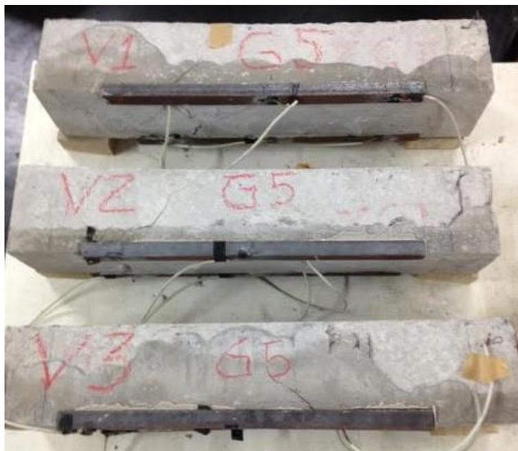
Nota-se na V1 a formação de uma fissura inclinada, à esquerda da extremidade do perfil, que se dirige até o centro do elemento ensaiado. Trata-se de uma fissura de cisalhamento com modo de ruína por cisalhamento seguido de descolamento da extremidade do reforço.
