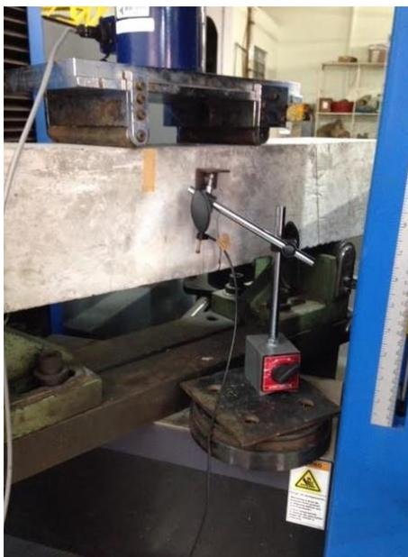
Observa-se no centro do vão da vigota o desenvolvimento de uma fissura de flexão típica, com o modo de ruína por escoamento da armadura de flexão positiva. A Figura 4.31 mostra as vigotas do grupo 01 após o ensaio de flexão, com o estado de fissuração evidenciado.
