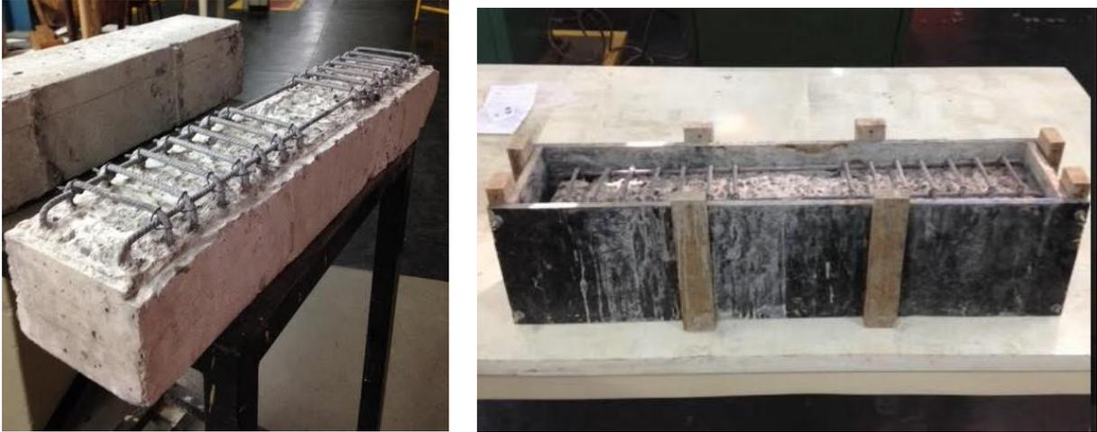
Para reforço das vigotas procedeu-se com a retirada da nata de cimento da superfície até a exposição do agregado graúdo. O procedimento foi realizado com esmerilhadeira elétrica acoplada com disco de polimento para concreto.
