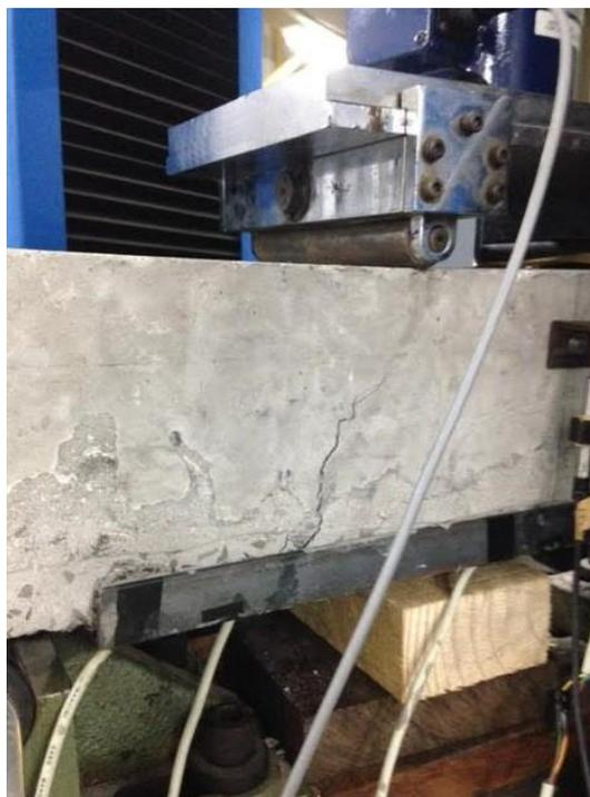
Observa-se à esquerda do centro do vão da vigota, o desenvolvimento de uma fissura de cisalhamento, com o modo de ruína por cisalhamento seguido de desprendimento da extremidade do reforço. A Figura 4.37 mostras as vigotas do grupo 03 após o ensaio de flexão, com o estado de fissuração evidenciado.
