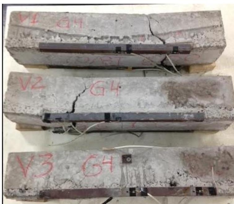
Nas vigotas V1 e V2 observa-se fissuras de grande abertura, inclinadas, atingindo a seção da viga quase toda, observa-se também o descolamento dos perfis nas extremidades, esquerda para V1 e direita para V2.
