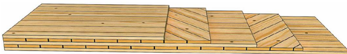
Figura 2.24 – Configuração geométrica dos painéis com alternância de 45° na orientação de lamelas adjacentes
