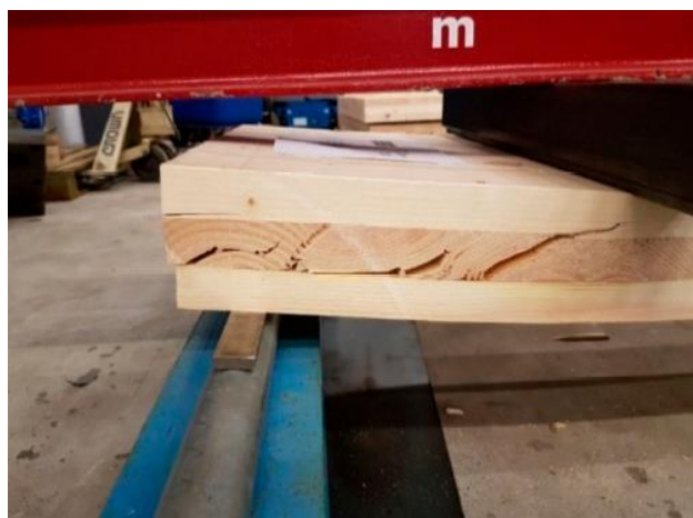
Figura 2.19 – Ruptura por rolling shear em painel de CLT com três camadas
