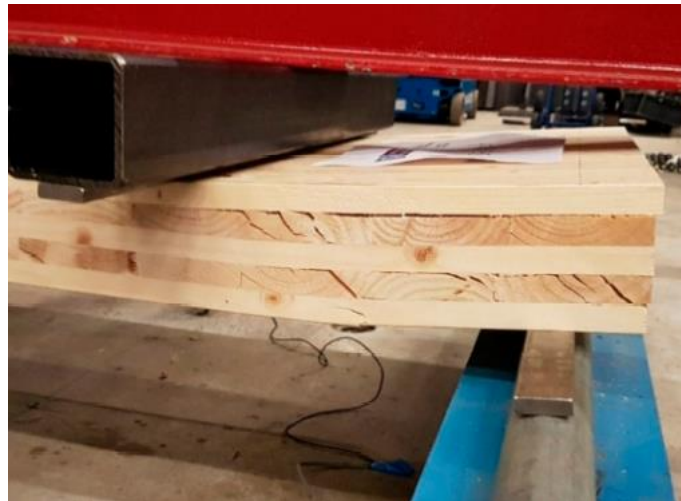
Figura 2.18 – Ruptura por rolling shear em painel de CLT com cinco camadas
