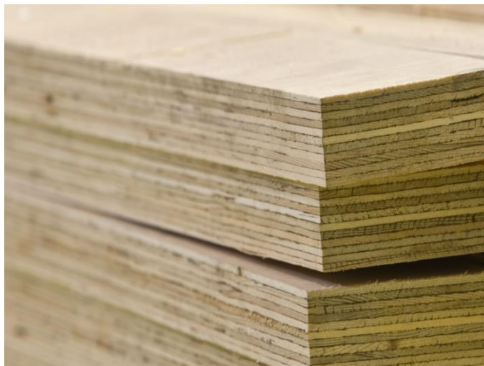
Figura 2.4 – Detalhe de painel de LVL
