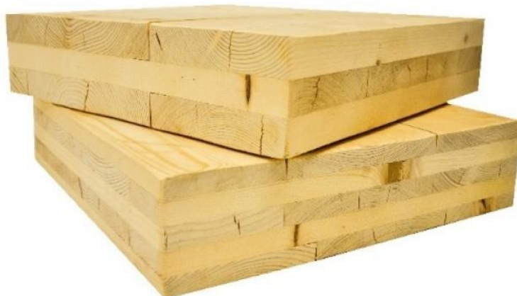
Figura 2.9 – Painéis de CLT com três e cinco camadas
