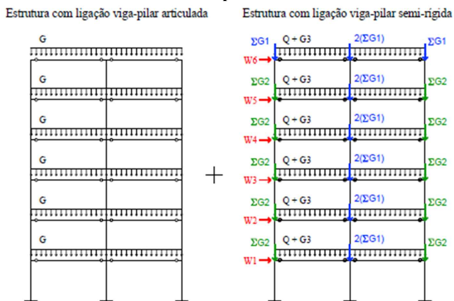
Figura 3.10 – Esquema de modelagem estrutural e soma dos efeitos para fases construtivas no processamento
