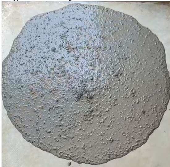
Figura 4.8 – Espalhamento do concreto
