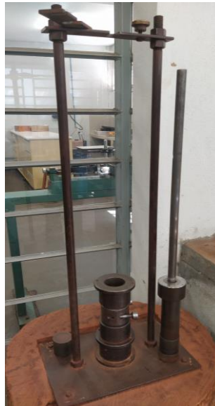
Figura 44 - Equipamento para compactação dos corpos de prova
