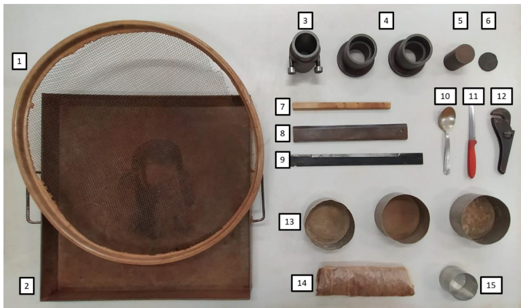
Figura 43 – Molde cilíndrico e acessórios para a moldagem do corpo de prova
