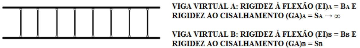
Figura 2.30 – Vigas virtuais do Método de Analogia ao Cisalhamento
