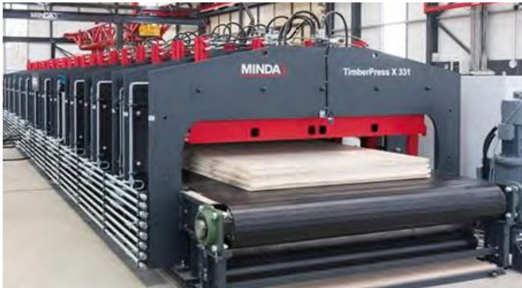
Figura 2.15 – Prensa hidráulica para produção de painéis de MLCC
