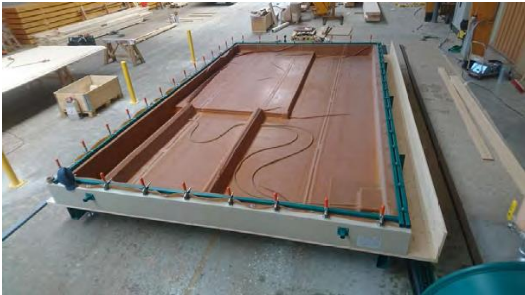
Figura 2.16 – Prensa à vácuo para produção de painéis de MLCC
