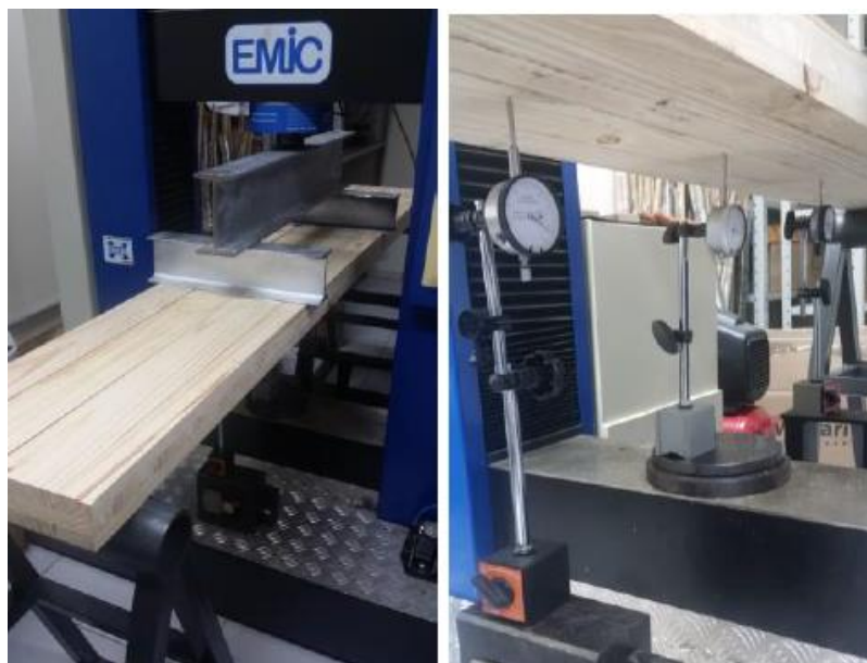
Figura 2.14 – Exemplo de aparato para realização do ensaio de flexão de quatro pontos
