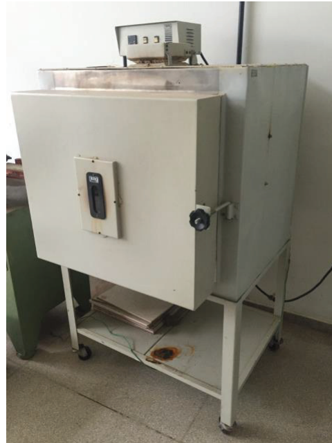
Figura 3.5 – Forno utilizado para submeter os corpos de prova a altas temperaturas
