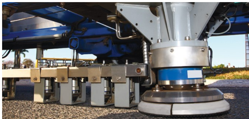
Figura 2.14 - Detalhe dos sensores e placa
