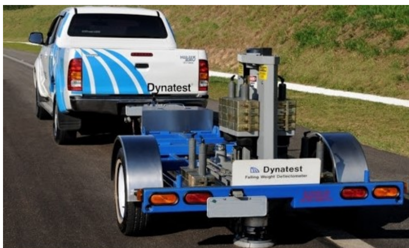
Figura 2.13 - FWD da marca Dynatest em operação
