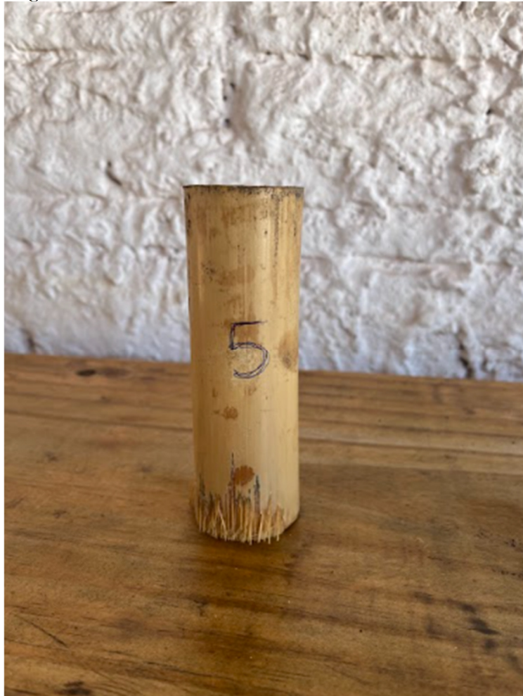
Figura 27- Modelo 5 - Coluna Reta Lisa- D45H15-CRLD45H15
