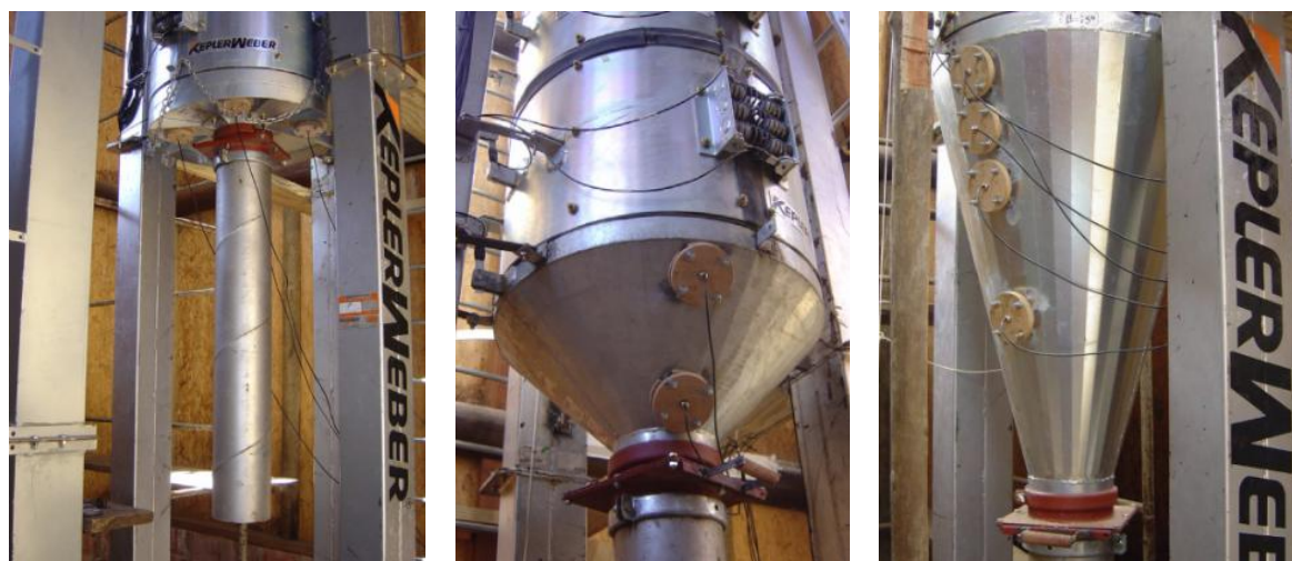
Figura 2.36 - Tipos de tremonha utilizadas no ensaio (a) Fundo plano, (b) Tremonha \alpha = 45^\circ e (c) Tremonha \alpha = 15^\circ
