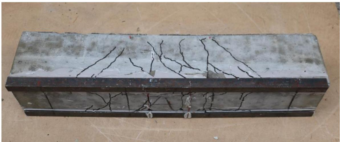
A Figura 6.19 apresenta a cantoneira separada do corpo de prova de concreto. Percebe-se que na região central ocorreu o arrancamento do cobrimento de concreto, deixando a armadura interna exposta como também pode-se observar na Figura 6.20.
