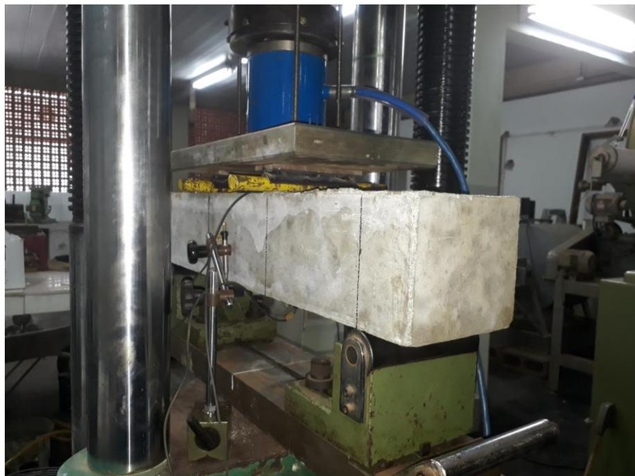
Para a obtenção dos valores da intensidade da carga aplicada nos corpos de prova foi utilizada uma célula de carga de capacidade para 100 toneladas (1000 kN) posicionada entre a rótula da prensa universal e a placa rígida superior. Esta célula de carga foi devidamente calibrada em uma prensa de compressão simples. O valor da carga aplicado na célula era adquirido manualmente por meio do leitor 3105C, da marca Alpha Instrumentos. Assim,
