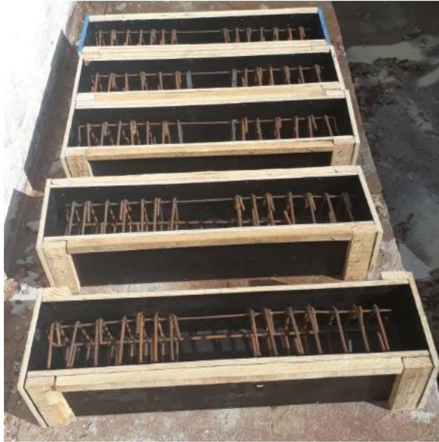
**Figura 6.4 – Corpos de prova prismáticos e cilíndricos**
