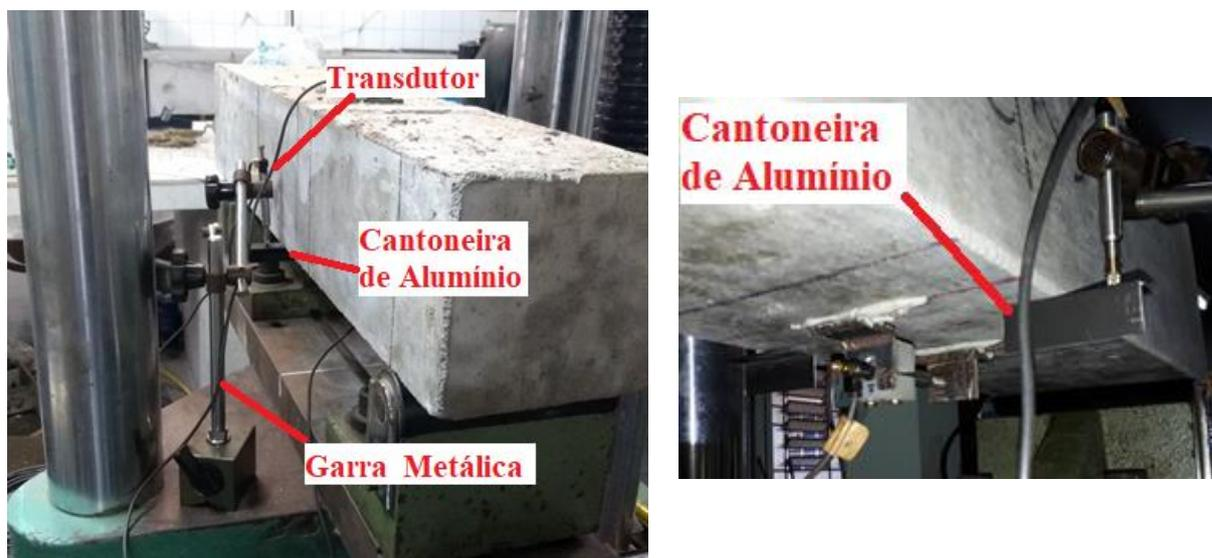
a) Montagem da garra metálica
