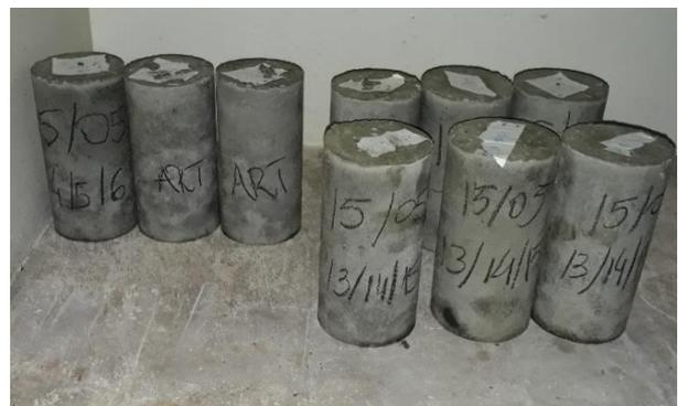
Corpos de prova cilíndricos
