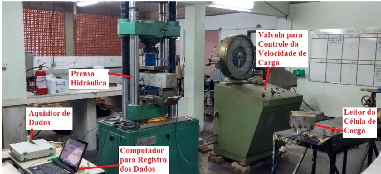
**Figura 6.11 – Montagem da Viga A1 na prensa para ensaio**
