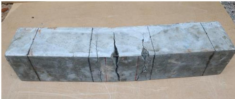
**Figura 6.15 – Fissuras da Viga A3**
