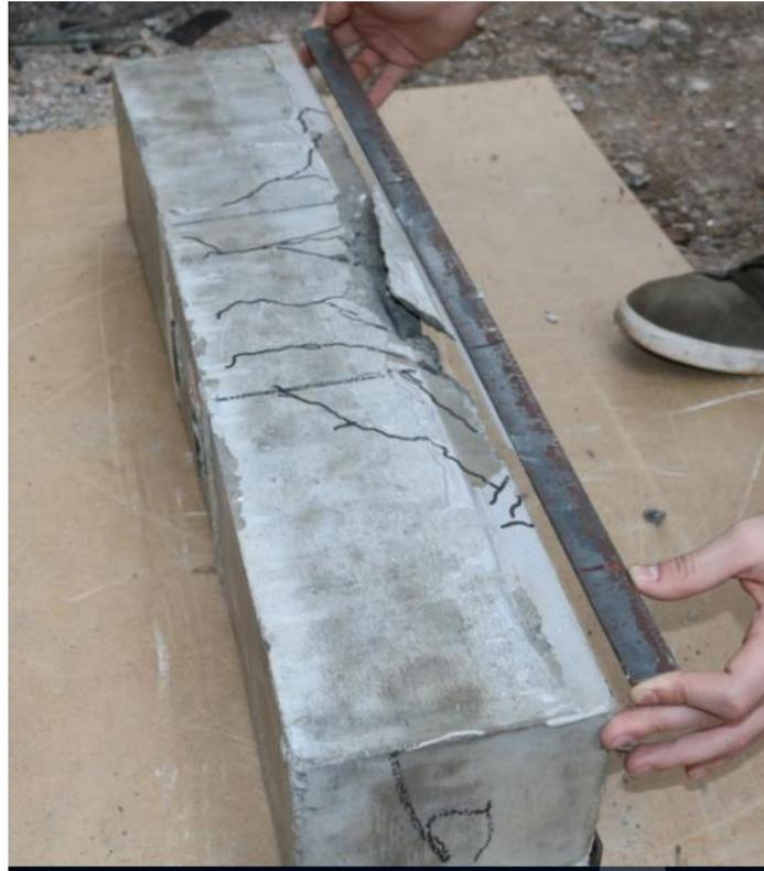
**Figura 6.20 – Armadura interna exposta da Viga B1**
