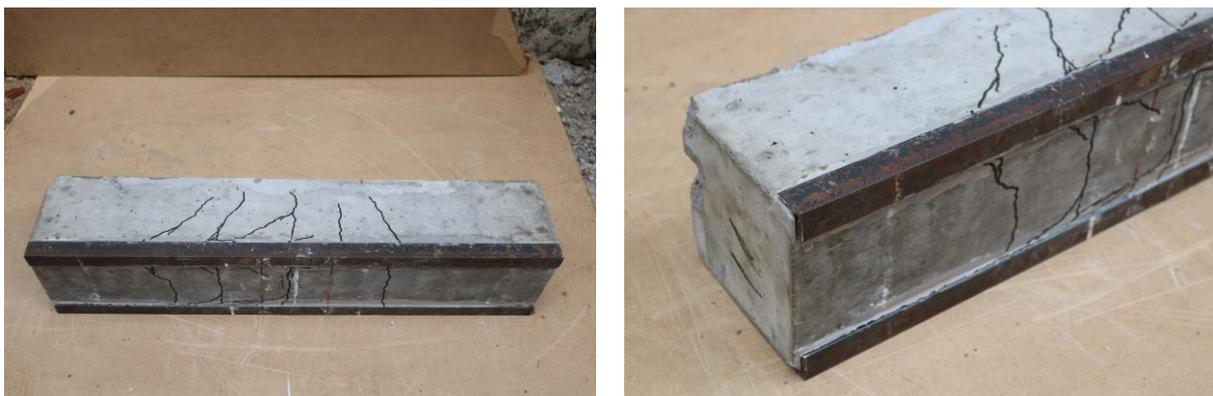
As Séries C e E são compostas de três corpos de prova cada. Estas séries foram reforçadas com cantoneiras de aço laminado de 1"x1/4". A diferença entre elas, assim como nas Séries B e D, está no tratamento da superfície do aço. Na Série C o reforço foi desengordurado e teve a pintura de proteção removida. Já na Série E foi mantida esta pintura.
