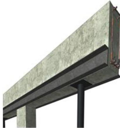
A ilustração apresentada na Figura 1.4 representa a configuração de um reforço fixado no banzo tracionado, quando há a necessidade de remoção de um pilar. Inicialmente, deverá ser feita a fixação do reforço no vão das vigas, seguido do escoramento da estrutura para posterior demolição do pilar. Feito isto, o reforço deverá ser complementado gerando uma região fragilizada pela ligação entre os materiais.
