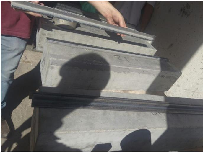
a) Aplicação do adesivo epóxi
