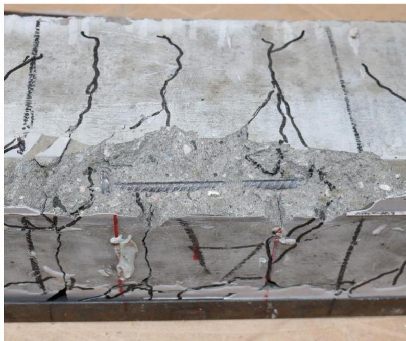
Nas Vigas B2 e B3 o descolamento do reforço ocorreu na interface adesivo-reforço no primeiro terço dos corpos de prova. Foi verificado que a superfície de concreto estava plana e bem preparada. Não foi identificado nada na superfície do reforço que indicasse falha na preparação deste material. Contudo várias medições foram feitas com paquímetro nos locais
