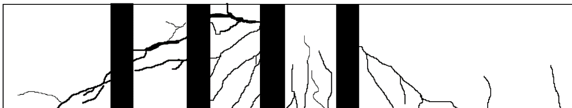
Figura 87 – Panorama de fissuração – Viga VC1
