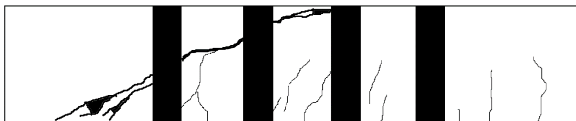
Figura 84 – Panorama de fissuração– Viga VC0-90
