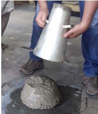
Figura 37 – Ensaio de abatimento de tronco de cone
