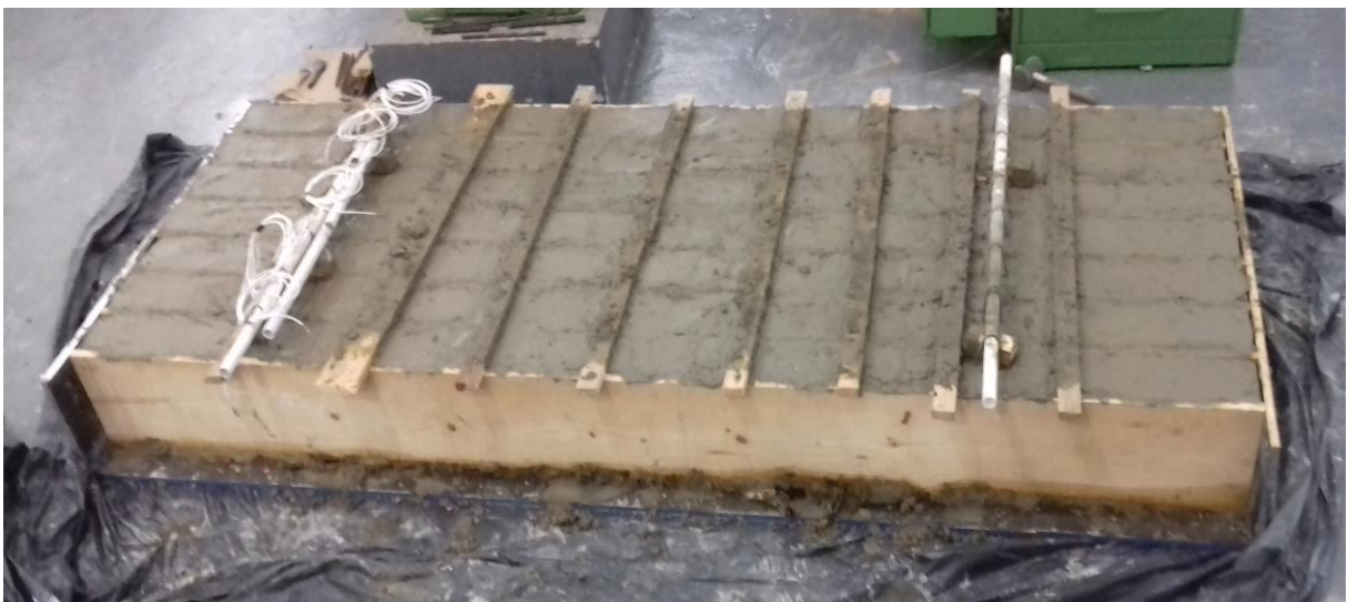
Figura 38 – Vigas após moldagem
