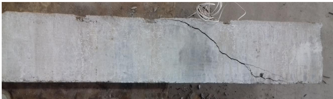
Figura 80 – Modo de ruptura – Viga VCR
