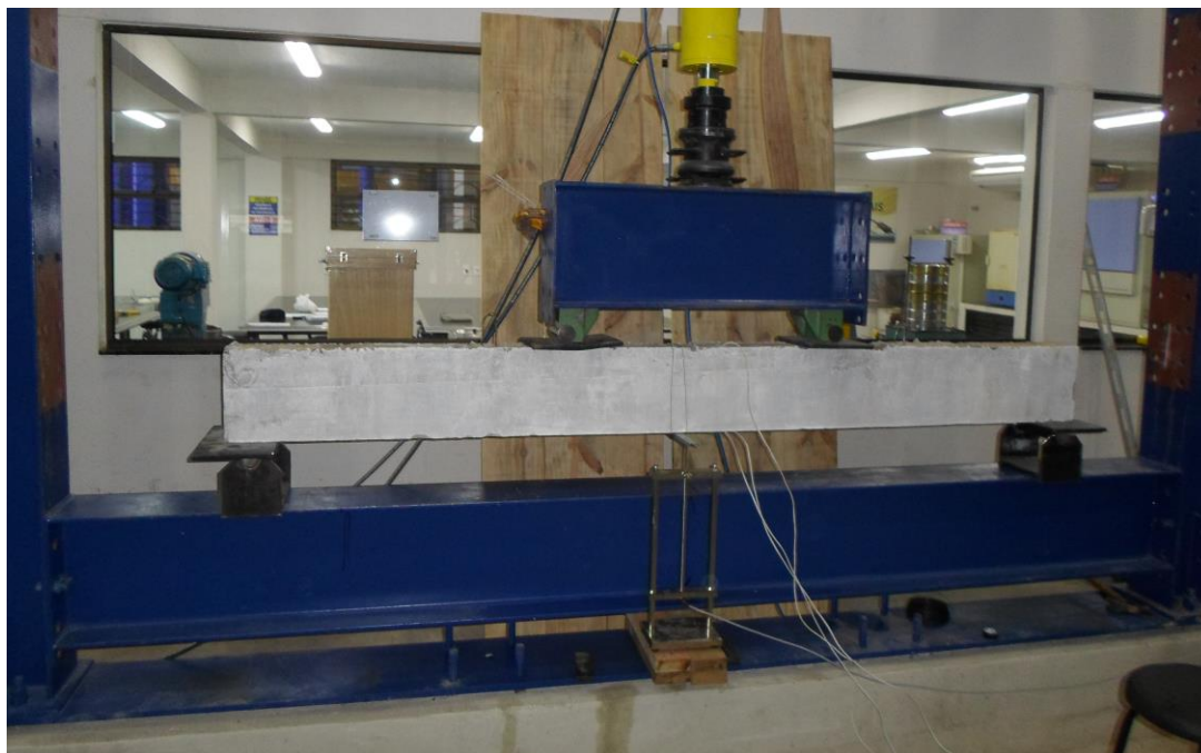
Figura 48 – Vigas com aplicação de carregamento
