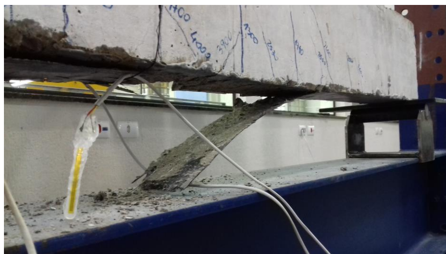
Figura 71 – Panorama de fissuração – Viga VF1
