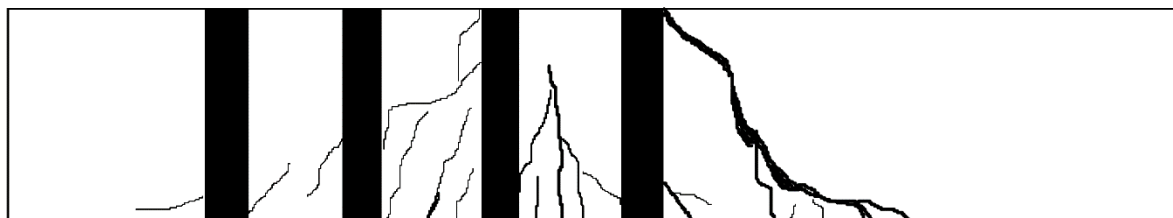
Figura 89 – Panorama de Fissuração – Viga VC2
