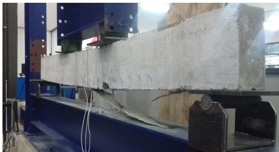
Figura 74 – Ruptura do reforço – Viga VF3
