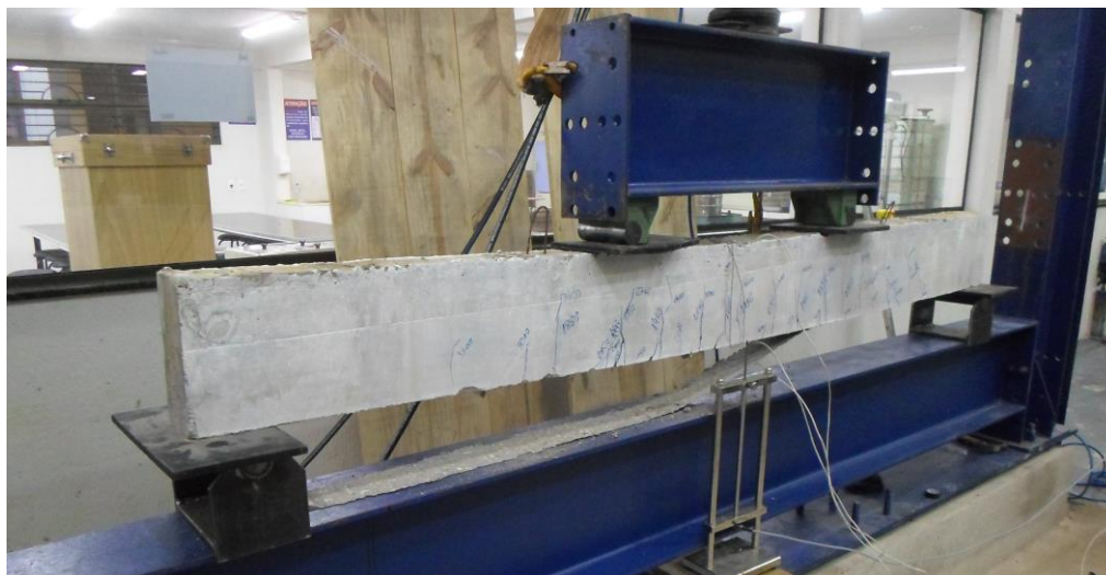
Figura 65 – Desprendimento do reforço – Viga VF0
