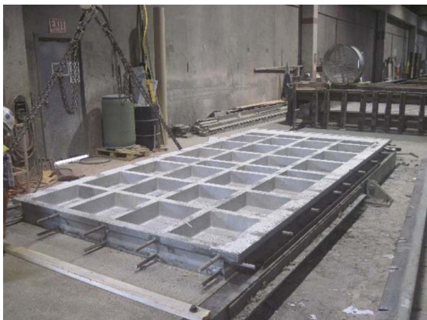
Figura 2.10: Laje nervurada em UHPC
