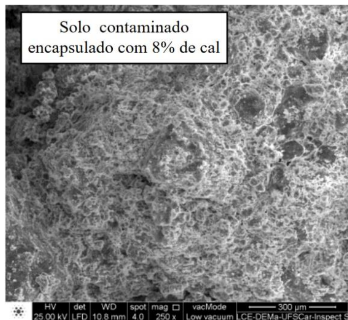
Figura 10: Microscopia eletrônica de varredura - Solo contaminado e encapsulado
