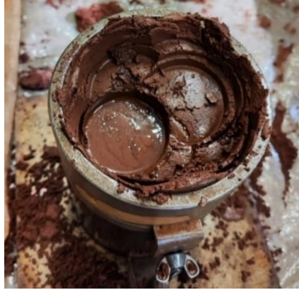
Figura 28: Ensaio de compactação 8% de óleo diesel
