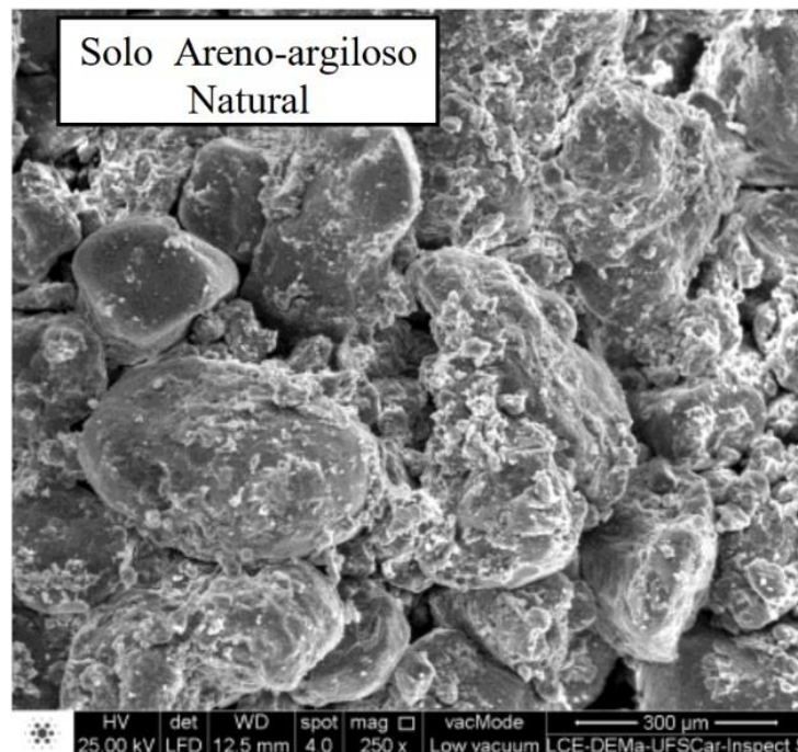
Figura 8: Microscopia eletrônica de varredura - Solo Natural
