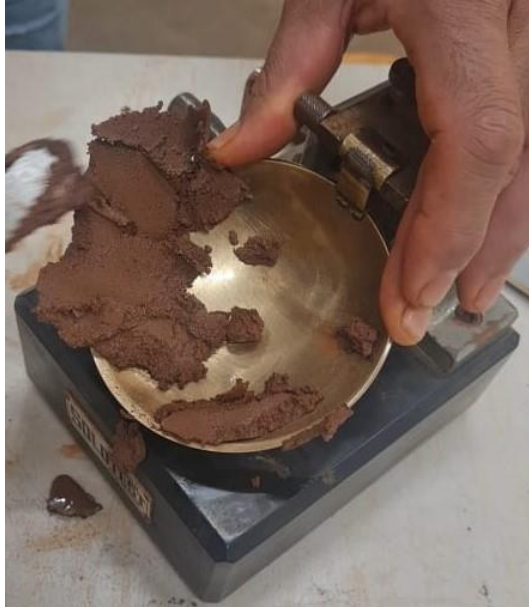
Figura 53: Ensaio de limite de liquidez para amostra de solo com óleo diesel
