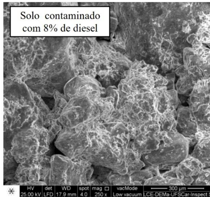
Figura 9: Microscopia eletrônica de varredura - Solo Contaminado
