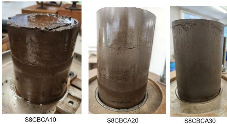
Figura 64: Compactação 8% OD tratado com CBCA
