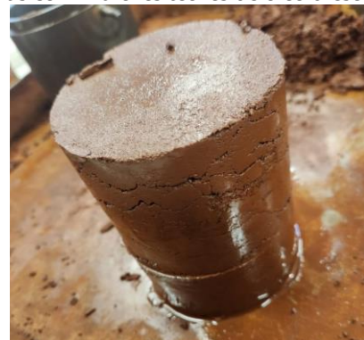
Figura 59: Aspecto visual da compactação para amostras com maiores teores de óleo diesel.
