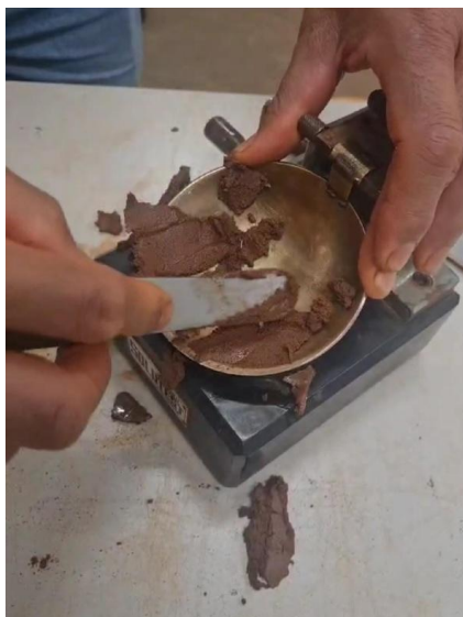
Figura 27: Ensaio de Limite de Liquidez- SN + 6% OD
