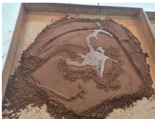
Figura 31: Adição de água ao solo contaminado para o ensaio de Compactação
