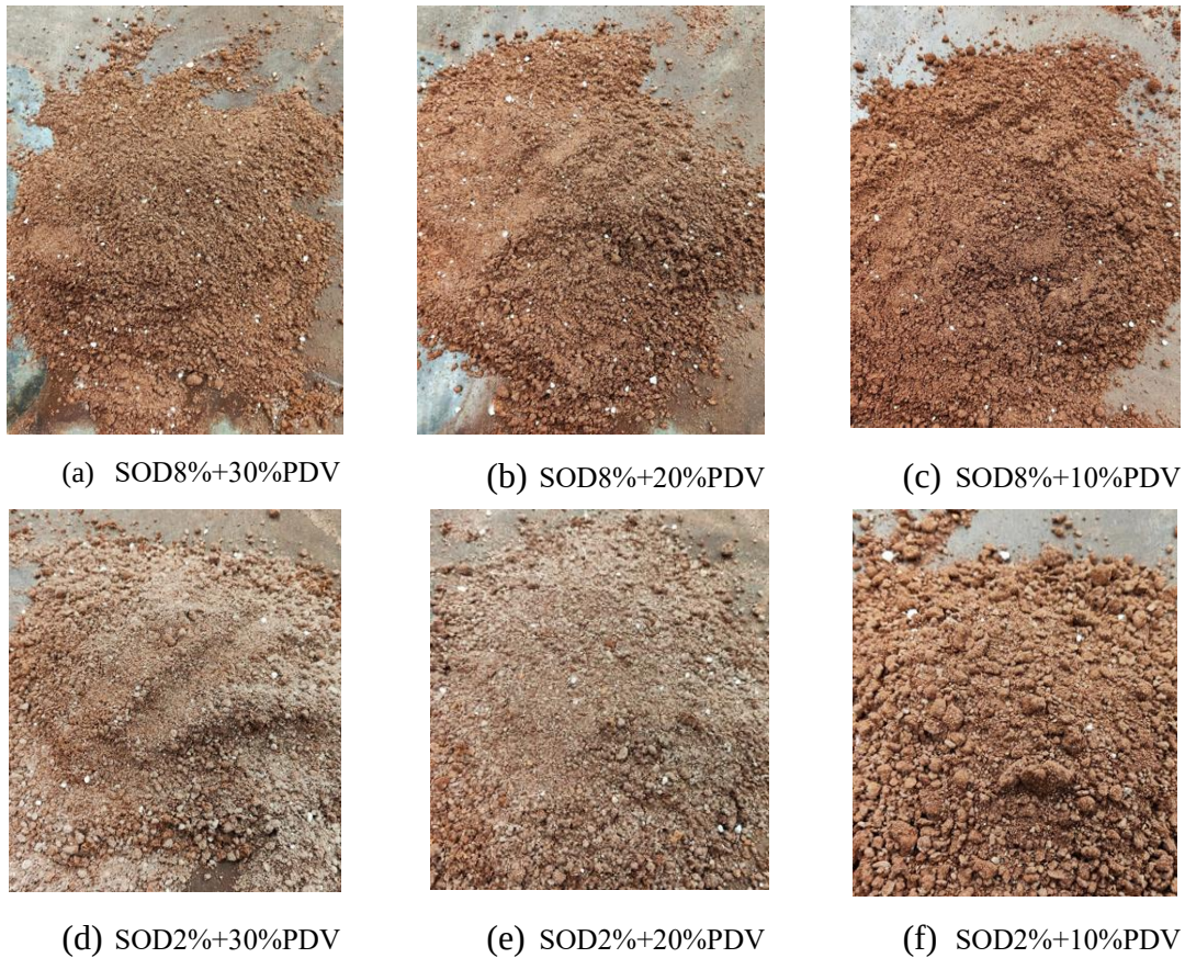
Figura 23: Amostras de solo contaminado com óleo diesel e tratado com pó de vidro
