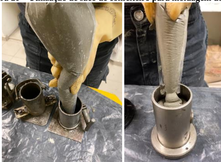
Figura 20 – Utilização de saco de confeiteiro para moldagem dos CPs
