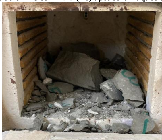
Figura 40 – Três dos CPs de UHPC sem PDV (V0) após serem aquecidos a uma taxa de 1°C/min
