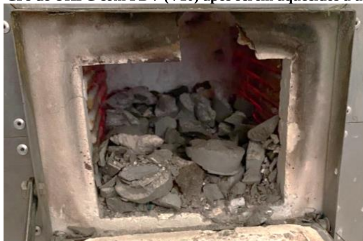
Figura 43 - CPs de UHPC com PDV (V10) após serem aquecidos a uma taxa de 1°C/min
