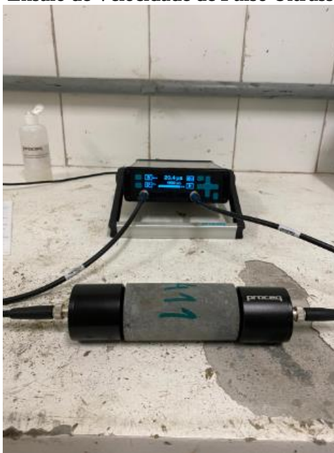
Figura 34 – Ensaio de Velocidade de Pulso Ultrassônico (VPU)
