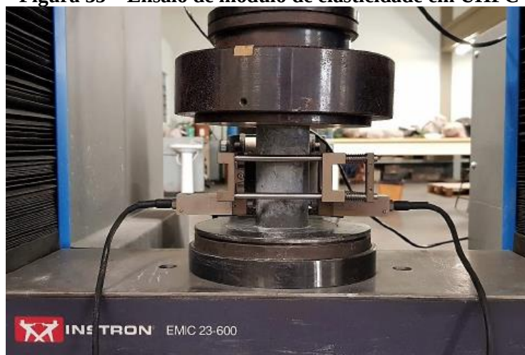
Figura 35 – Ensaio de módulo de elasticidade em UHPC
