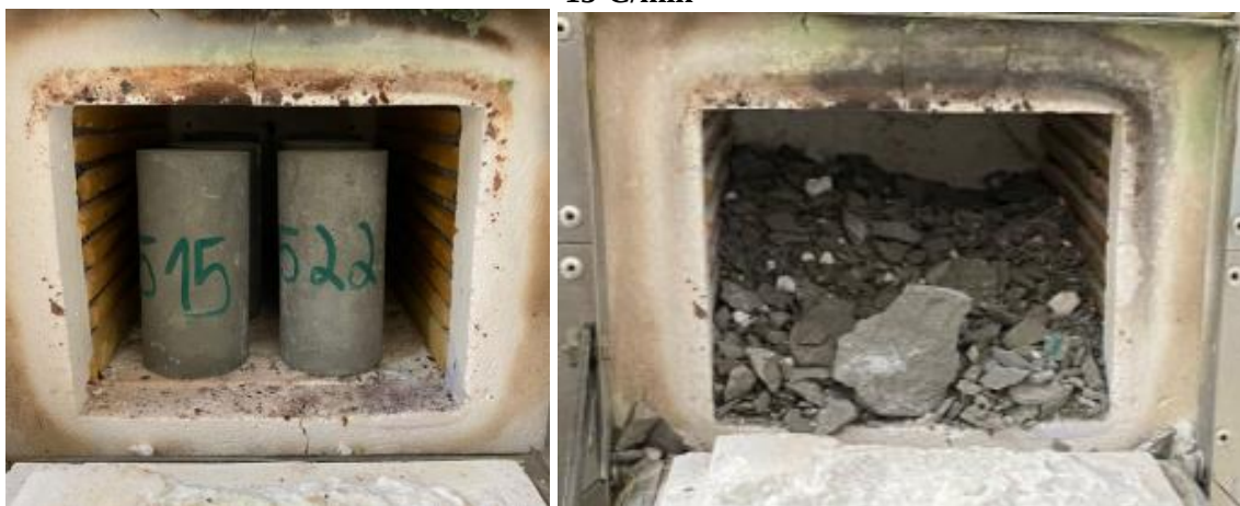
Figura 38 – CPs de UHPC sem PDV (V0) antes e após serem aquecidos a uma taxa de 15°C/min
