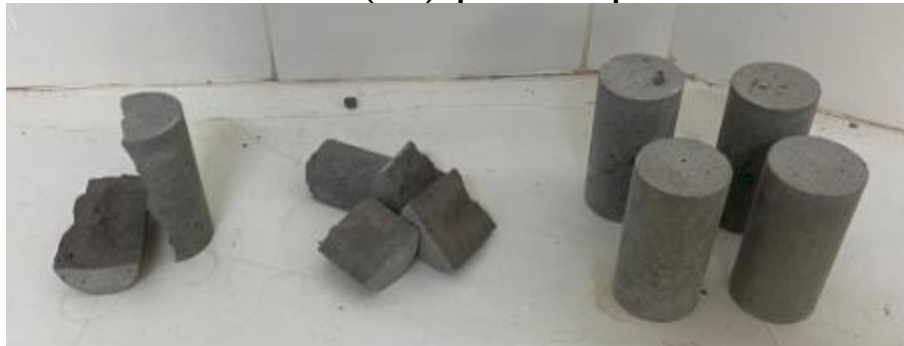
Figura 41 – CPs de UHPC com PDV (V10) após serem aquecidos a uma taxa de 15°C/min
