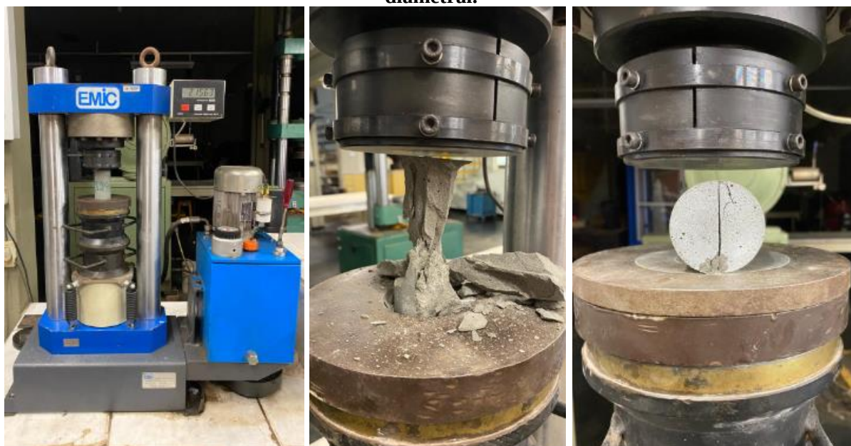
Figura 24 – Prensa hidráulica durante o ensaio de resistência à compressão axial e diametral.
