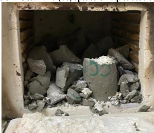
Figura 39 – CPs de UHPC sem PDV (V0) após serem aquecidos a uma taxa de 5°C/min
