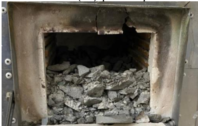
Figura 42 – CPs de UHPC com PDV (V10) após serem aquecidos a uma taxa de 5°C/min
