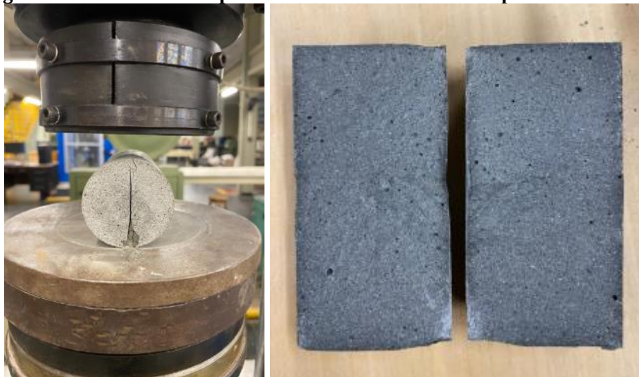
Figura 33 – CP de UHPC após o ensaio de resistência à compressão diametral.
