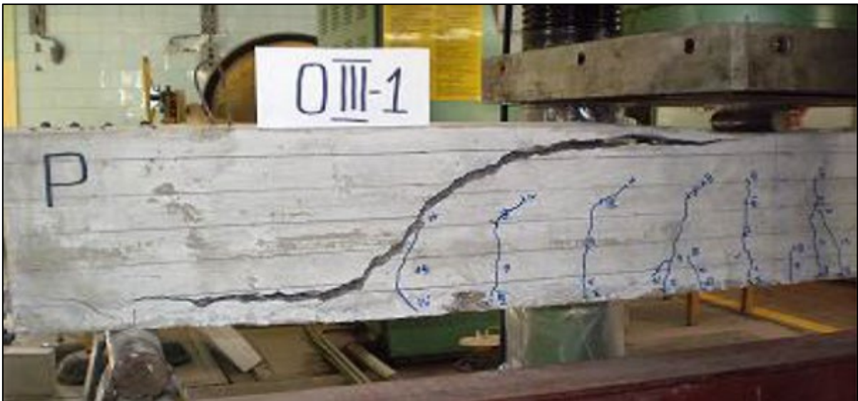
Figura 35 - Distribuição de fissuras na ruptura em ensaio experimental de viga fletida
