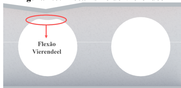
Figura 2.6: Mecanismo de Vierendeel
