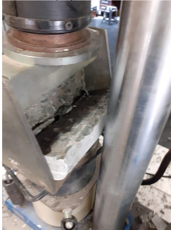
Figura 34 – Ensaio de Tração por Compressão Diametral no Concreto
