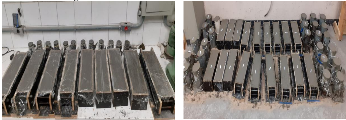
Figura 30 – Amostras Cilíndricas e Prismáticas na Fôrma
