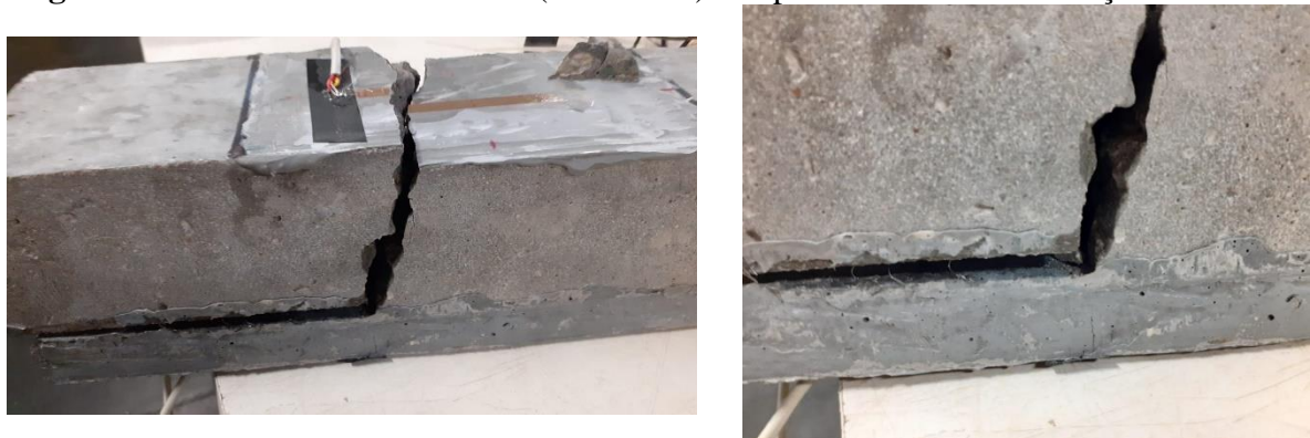
Figura 64 – Amostra Concreto C85 (ref. 30mm) rompida na Interface Reforço x Substrato
