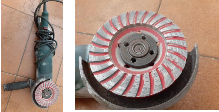
Figura 43 – Ferramentas usadas para o preparo do substrato em concreto
