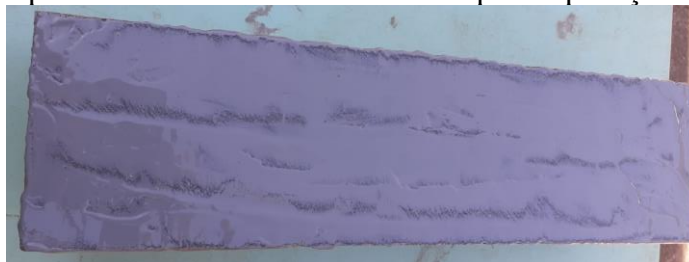
Figura 45 – Superfície do substrato em concreto após a aplicação da resina epóxi
