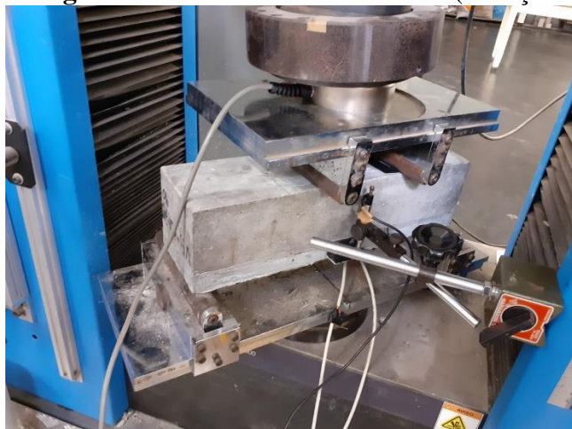
Figura 57 – Amostra Concreto C70 (reforço 20mm) após o Ensaio de Flexão 4 pontos
