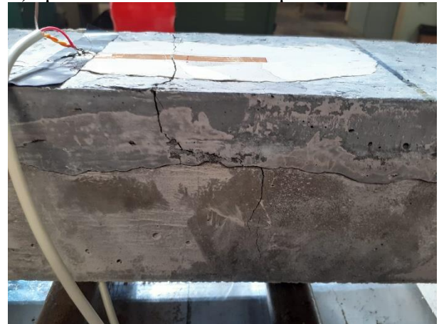
Figura 60 – Amostra Concreto C70 (reforço 30mm) após o Ensaio de Flexão 4 pontos
