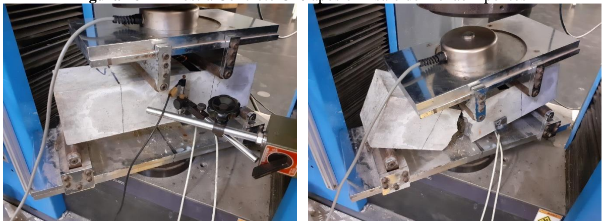
Figura 48 – Amostra Concreto C40 após o Ensaio de Flexão 4 pontos
