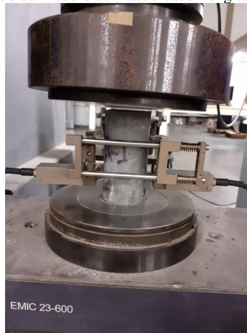
Figura 38 – Ensaio de Módulo de Elasticidade Longitudinal no UHPFRC
