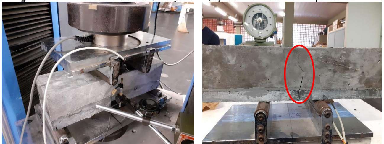
Figura 62 – Amostra Concreto C85 (reforço 20mm) após o Ensaio de Flexão 4 pontos
