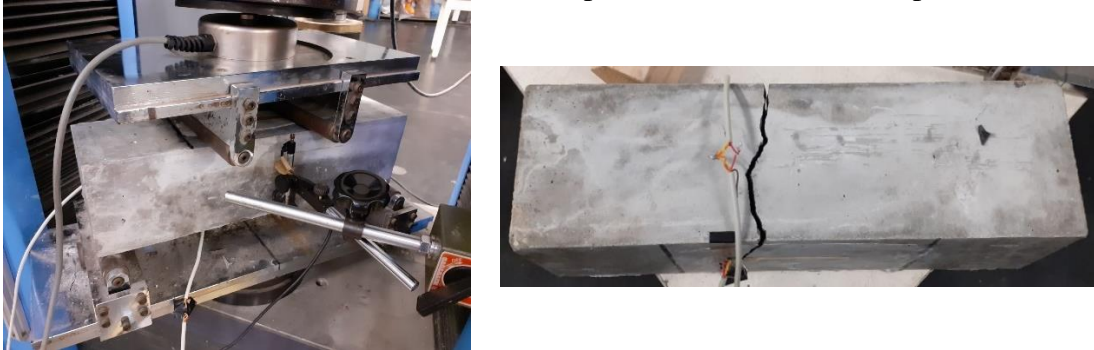
Figura 49 – Amostra Concreto C70 após o Ensaio de Flexão 4 pontos
