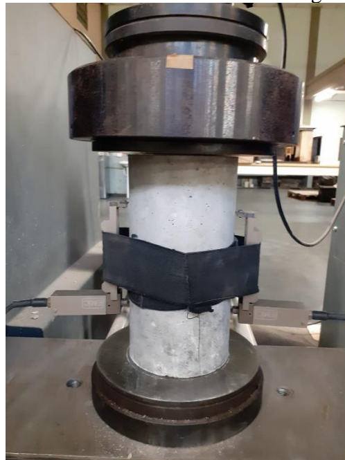
Figura 35 – Ensaio de Módulo de Elasticidade Longitudinal no Concreto
