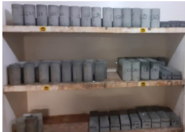
Figura 31 – Amostras Cilíndricas e Prismáticas na Câmara Úmida
