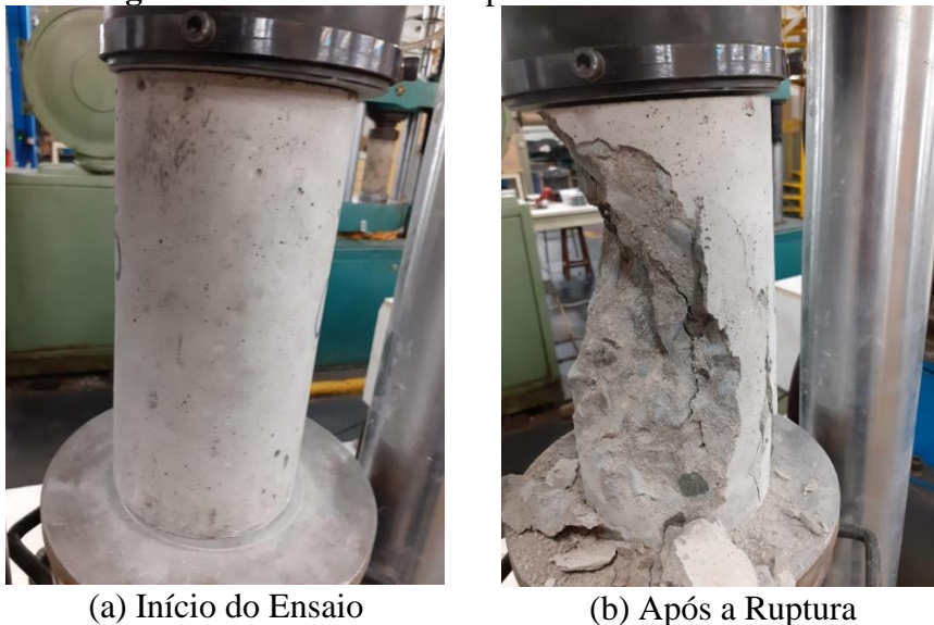
Figura 33 – Ensaio de Compressão Axial no Concreto
