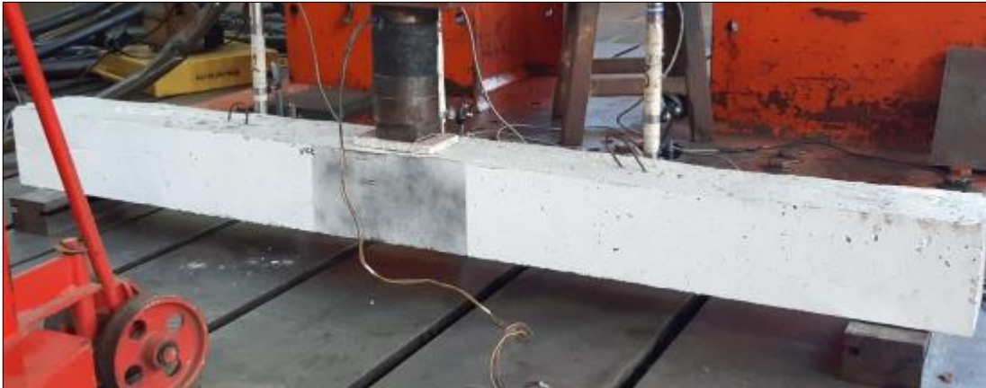
Figura 12 – Amostras Submetidas ao ensaio de flexão de 3 pontos de Granato (2020)
