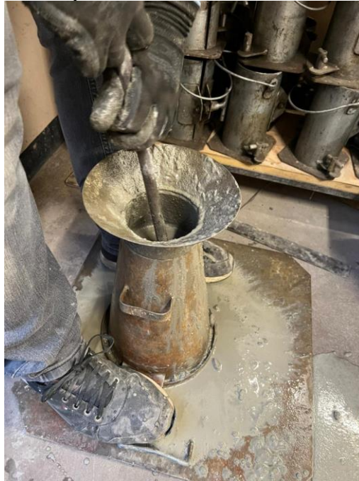
Figura 29 – Slump Test realizado no concreto convencional
