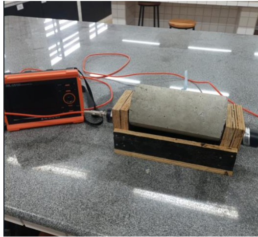
Figura 3.8 – Ensaio utilizando ultrassom em posição direta
