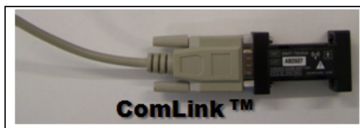
Figura 3. Receptor ComLink – capaz de transferir os dados do monitor para um computador pessoal.
